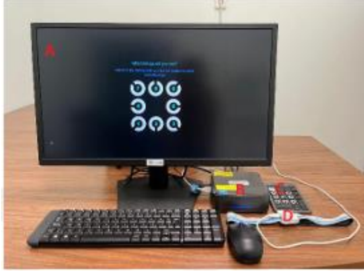
Şekil 3.1. fHIT cihazı, (A) Monitör, (B) Kasa, (C) Klavye, (D) Baş bandı
