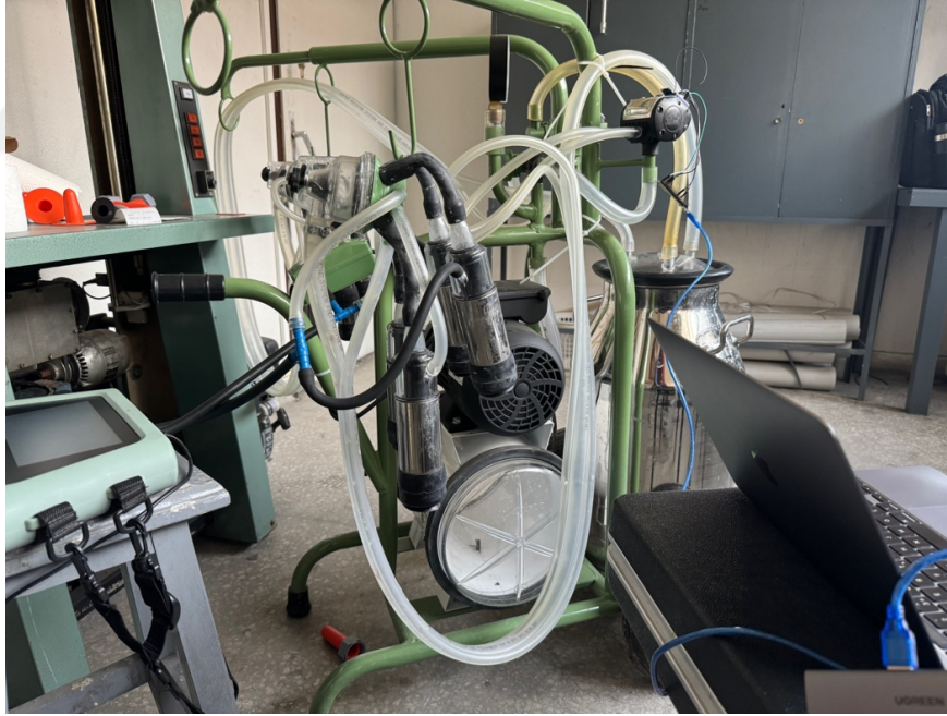
Şekil 4.4. Kovalı/güğümlü süt sağım makinesi ESP32 tabanlı canlı analiz sisteminin deneysel kurulumu
