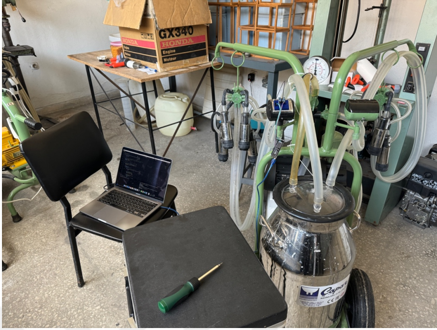
Şekil 4.3. Kovalı/güğümlü süt sağım makinesi pulsatör analiz cihazı ve veri toplama arayüzü
