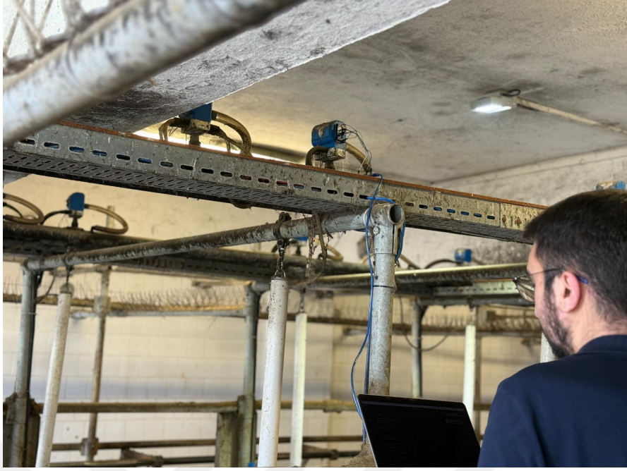
Şekil 4.5. Balıkkılıçığı süt sağım sistemi pulsator analiz cihazı ve veri toplama arayüzü
