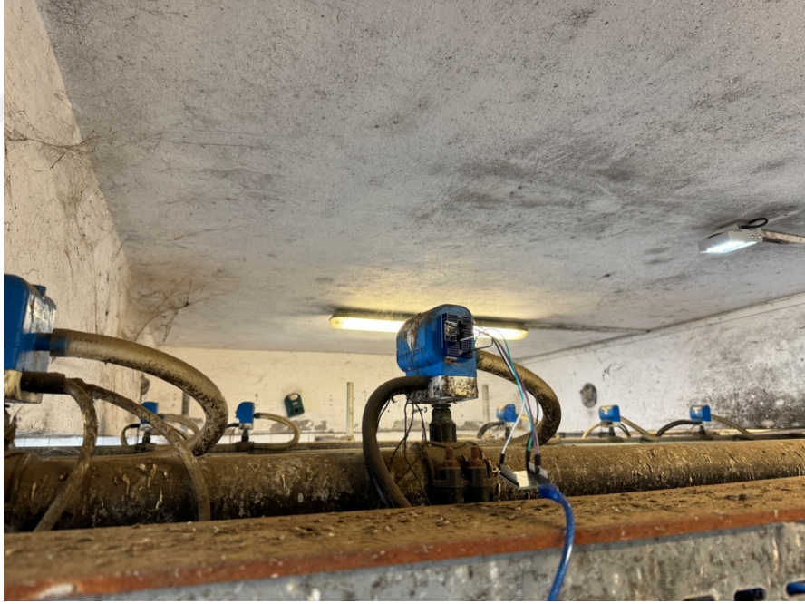
Şekil 4.6. Balıkkılıçığı süt sağım sistemi ESP32 tabanlı canlı analiz sisteminin deneysel kurulumu
