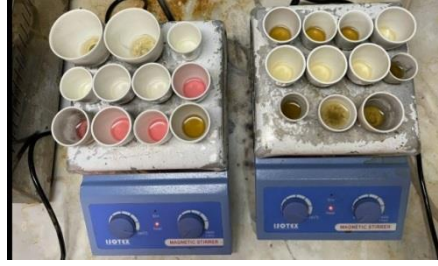
Resim 3.3. Kül tayini esnasında örneklerin yakılması
