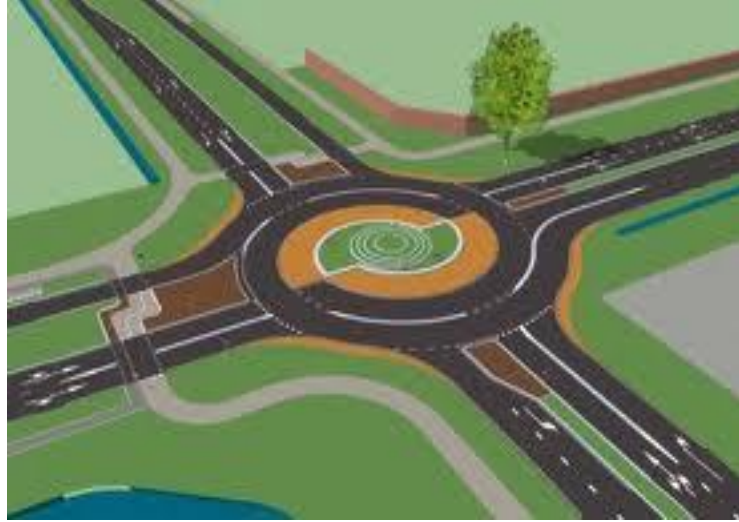
Şekil 2.2: Dönel (Yuvarlak ada) Kavşak
