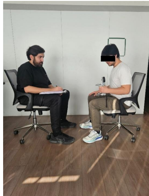
Şekil 3.5. Kaba Kavrama Kuvvetinin Ölçülmesi
