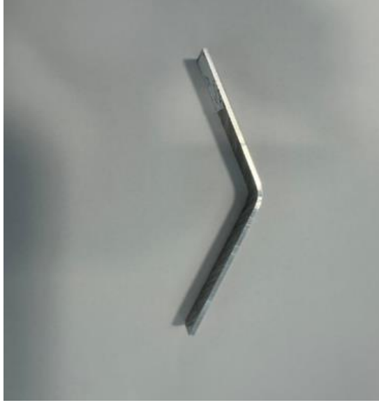
Şekil 5.11 1 Numaralı kaynaksız numunenin eğme deneyi sonrası görüntüsü
