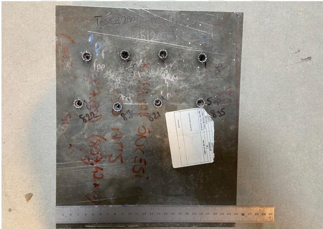
Şekil 5.27 Balistik deney sonrası levhanın ön yüzey görüntüsü
