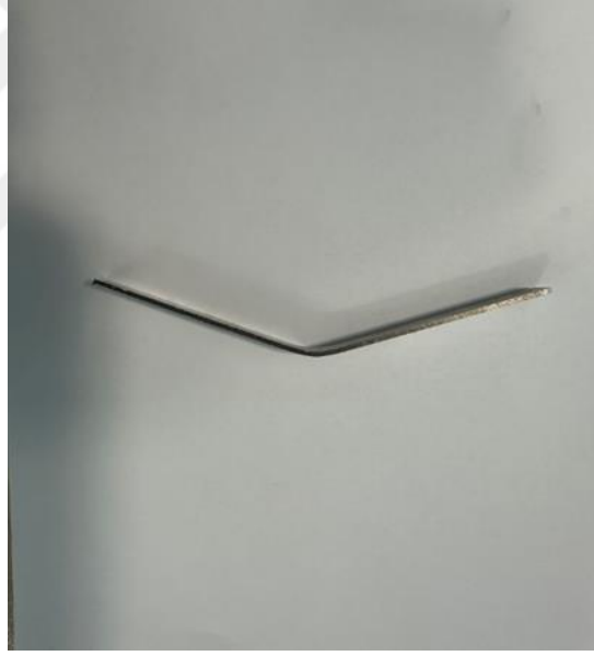
Şekil 5.12 4 Numaralı kaynaklı numunenin eğme deneyi sonrası görüntüsü
