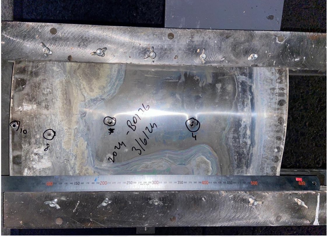
Şekil 5.32 Balistik deneyler sonrası levhanın şahit plaka görünümü
