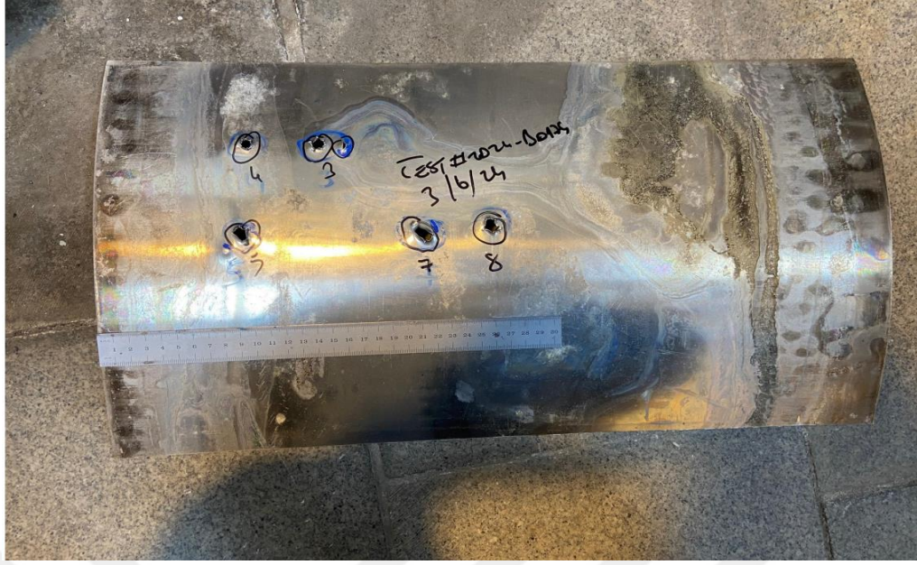
Şekil 5.28 Balistik deney sonrası şahit plaka görüntüsü
