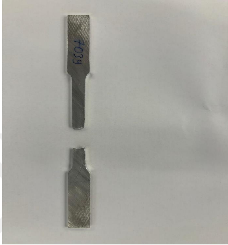
Şekil 5.3 4 No'lu kaynaklı çekme deneyi numunesinin deney sonrası görüntüsü
