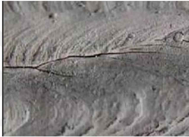
Şekil 2.16 Kaynak işlemi sırasında oluşan kaynak çatlağı kusuru (Kurgan, 2023)
