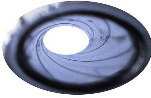
Şekil 2.21 Yiv-set yapısı (“yiv,” 2024)
