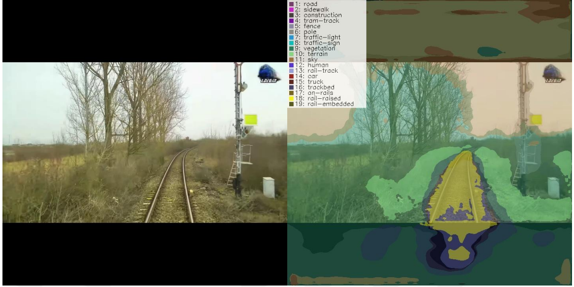
Şekil 6.12. DeepLabV3+ Kullanarak Segmentasyon Tabanlı Geometrik Çıkarım Örneği - 3
