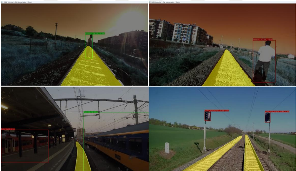
Şekil 6.19. DeepLabV3plus + YOLOv11 + ZED2 Örneği - 2
