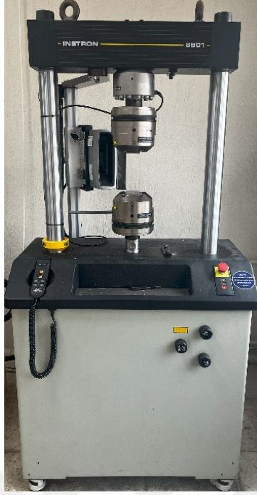
Resim 2.3: Biyomekanik ölçümlerde kullanılan servo-hidrolik sistemle çalışan test cihazı.
