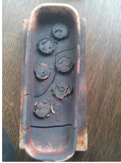
Şekil 5. 7. Sinterleme işlemi sonrasında elde edilen numuneler
