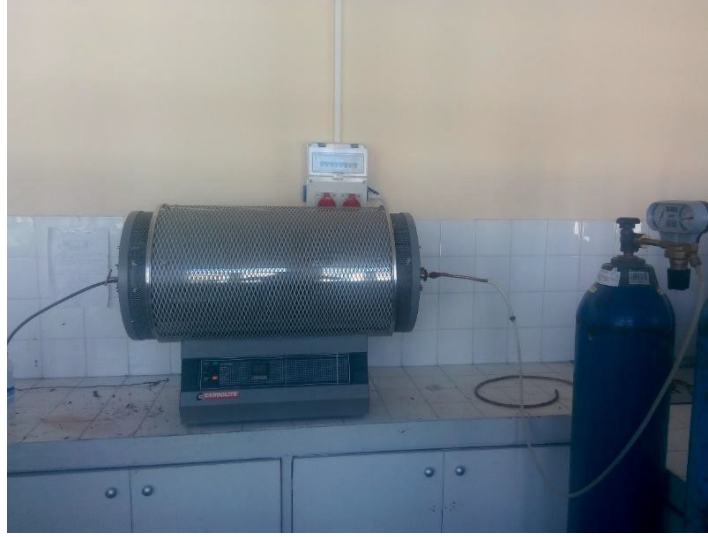
Şekil 5. 6. Sinterleme kullanılan Carbolite fırın ve Argon gazı bağlantısı
