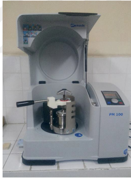
Şekil 5. 3. Retsch marka PM100 modelindeki tek potlu bilyeli değirmen
