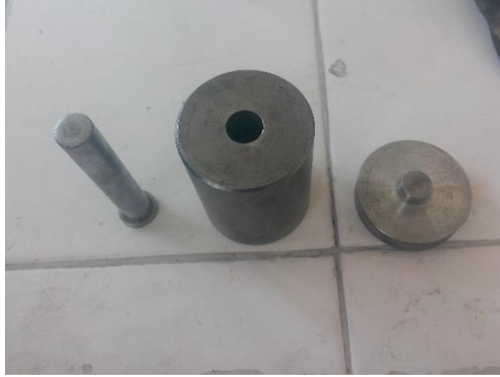
Şekil 5. 4. Tozların sıkıştırılması için kullanılan kalıp
