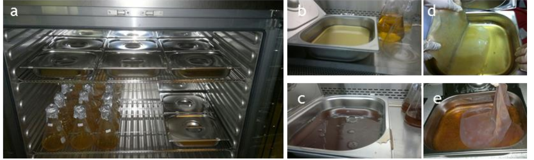
Şekil 4.6 Yüz maskesi için yapılan üretimler. (a) İnkübatör içerisinde genel görünüm. (b) Standart HS besiyerinde ekim. (c) CHb besiyerinde üretim. (d) Standart HS besiyerinde üretilen BS'nin hasatı. (e) CHb besiyerinde üretilen BS'nin hasatı.
