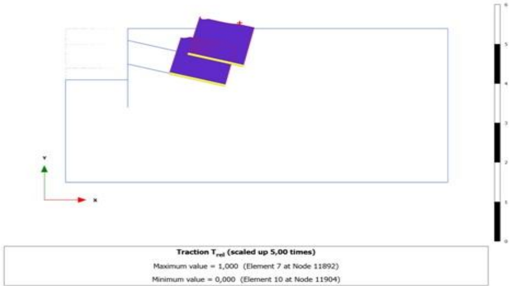
Şekil 5.19b M1-100-150 modeli için relatif birim çevre sürtünme kuvveti ( T_{rel} )
