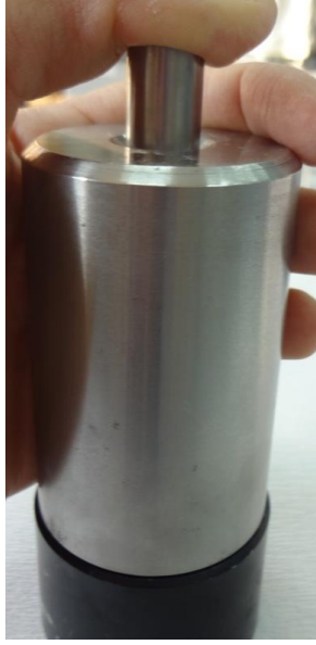
Şekil 5.6 Tamponlama işlemi ve tamponlamadan sonraki kompozitin “ön”şekil şematik görünümü
