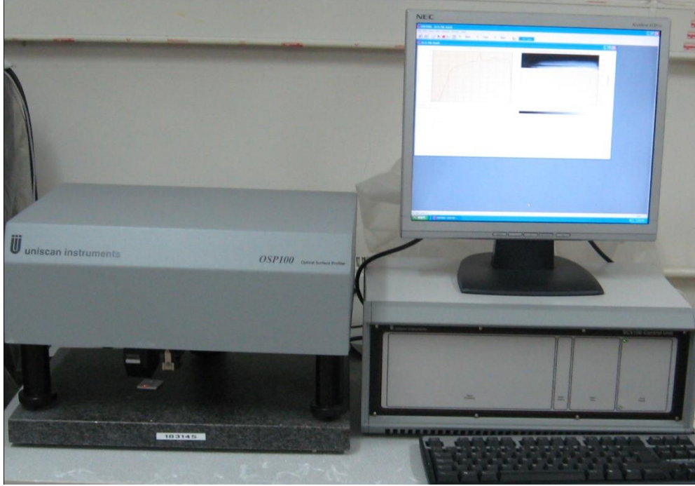
Şekil 4.3 OSP 100 A Optik Non-Contact Yüzey Profillendirme Sistem A) LK -031 kodlu lazer ünitesi; B)Lazer verilerinin bilgisayara aktarıldığı ünite C) Lazer kontrolünün yapıldığı OSP 100A yazılım yüklü bilgisayar
