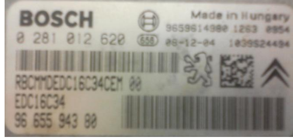
Şekil 3. 2 Bosch EDC16C34 ECU
