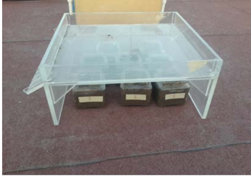
Şekil 2.14 Toprakta laboratuvar ölçekli biyoremediasyon çalışma düzeneği
