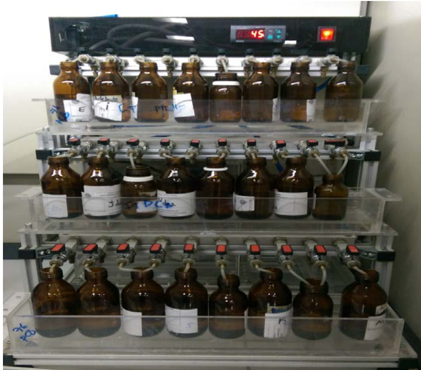
Şekil 2.17 Azot gazı altında 45 0 C'de solvent uçurma işlemi
