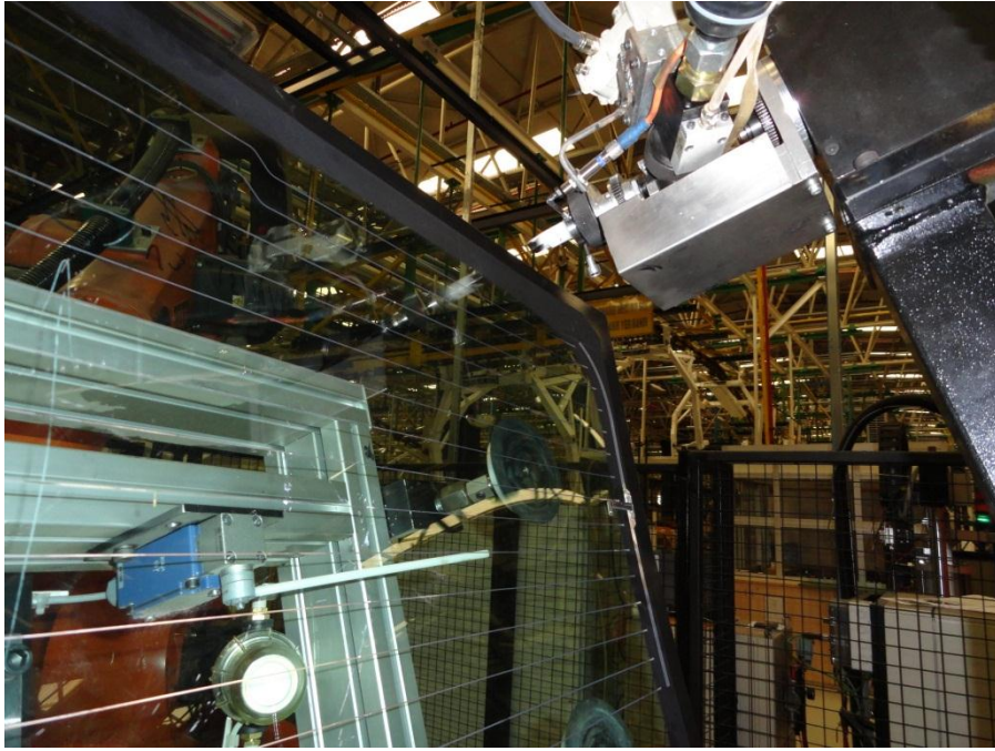
Figure: Positionnement de la vitre devant la buse de mastic pour l'encollage de celui-ci
