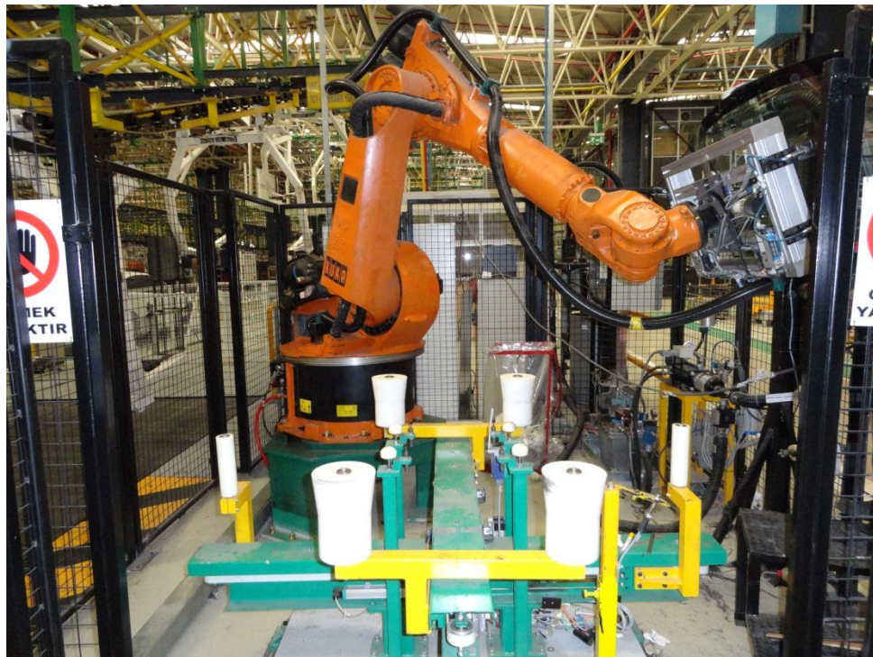
Figure: Photo du robot industriel KUKA, du centreur mécanique, du préhenseur à ventouse et de la lunette arrière accrochée au préhenseur
