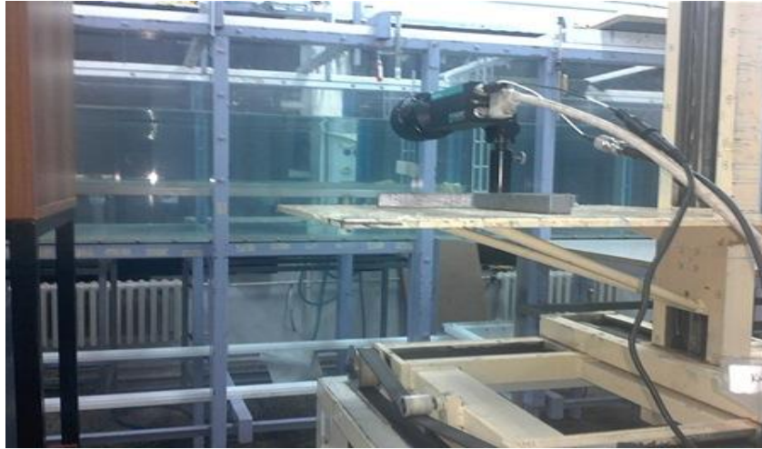
Şekil 4.3 Deney düzeneğinde kameranın yerleşimi
