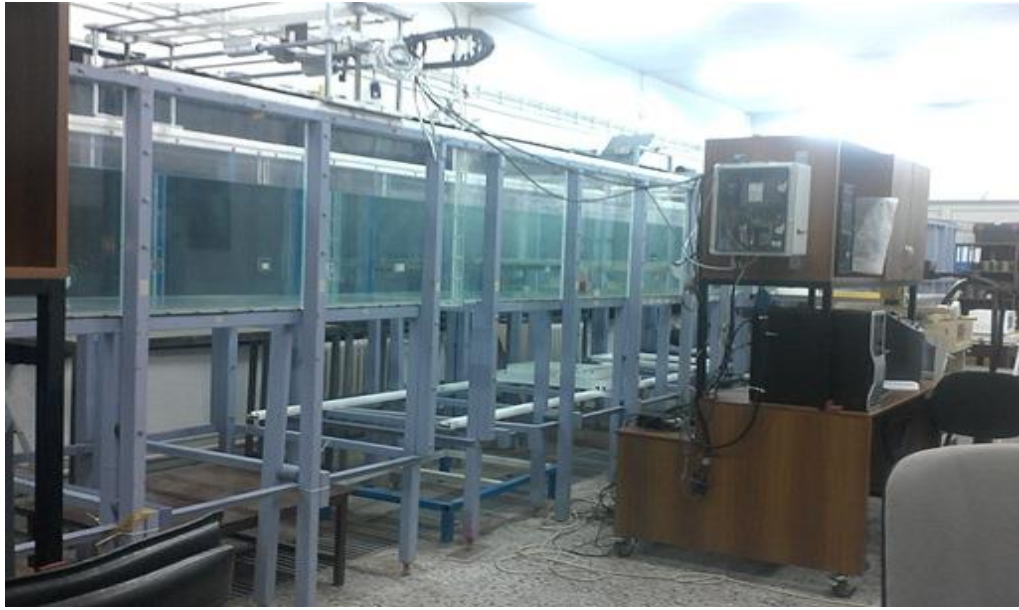
Şekil 3.6 Deney kanalının görünümü
