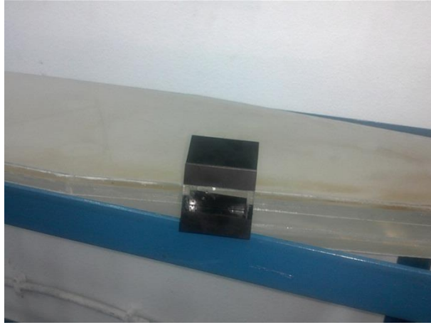
Şekil 3.16 Üstten görünüş için z/h=0,5 yüzeyi için bina modelinin boyanmış hali
