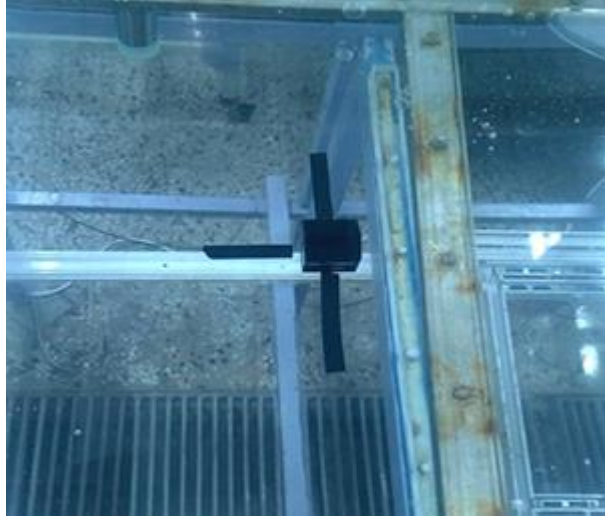
Şekil 5.2 Üstten görünüş için tek bina modelinin yerleşimi
