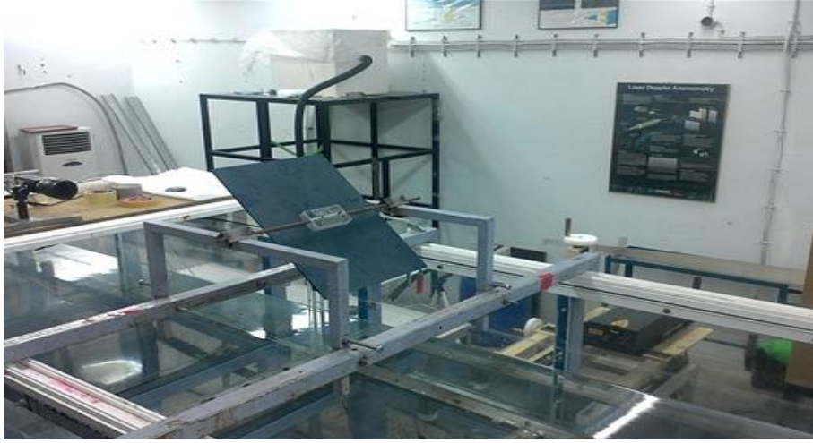
Şekil 4.7 Deney düzeneğinde üst görünüş için kamera ve aynanın yerleşimi
