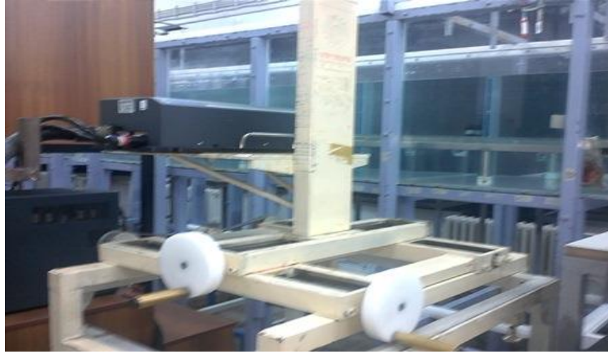
Şekil 4.8 Deney düzeneğinde üst görünüş için kamera ve aynanın yerleşimi
