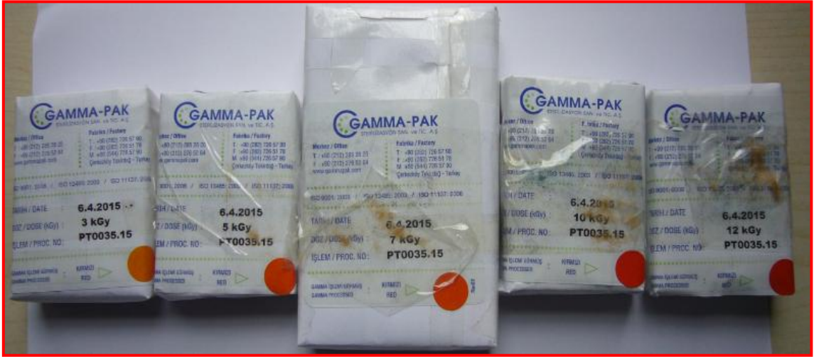
Şekil 4.6. Gamma-Pak ışınlama tesisinde ışınlanan numuneler
