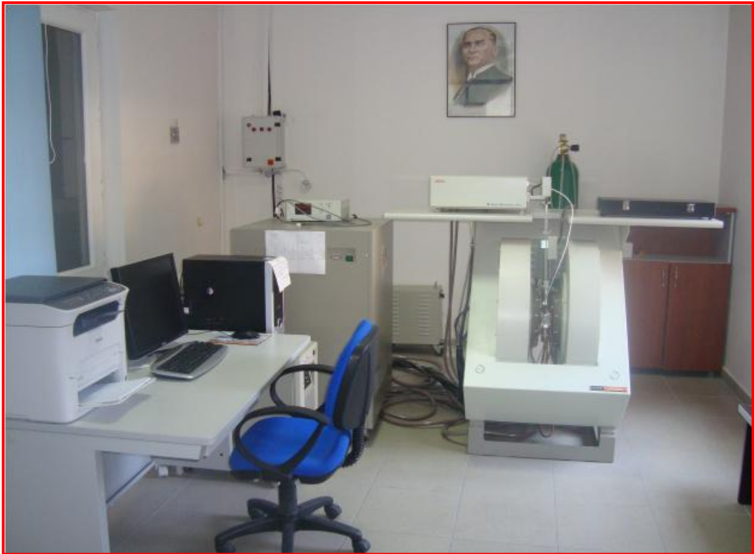
Şekil 3.5. Selçuk Üniv. İLTEK de bulunan JEOL JES-FA300 X-band ESR spektrometresi
