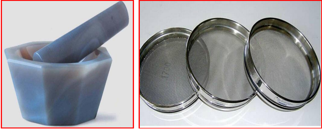
Şekil 4.4. Agat havan ve farklı tane boyutlarında eleklerimiz
