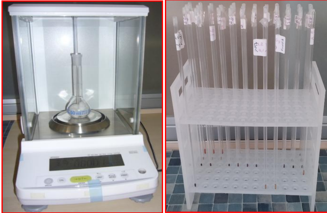
Şekil 4.7. Hassas teraziye tartılan ve ESR tüplerine konulan örnekler
