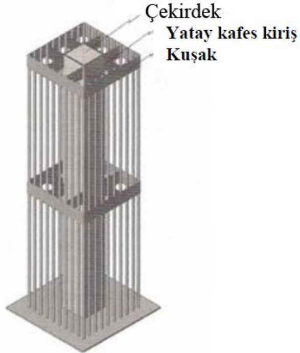
Şekil 3.19. Yatay kafes kirişli ve kuşaklı sistem (Çırpı, 2013).
