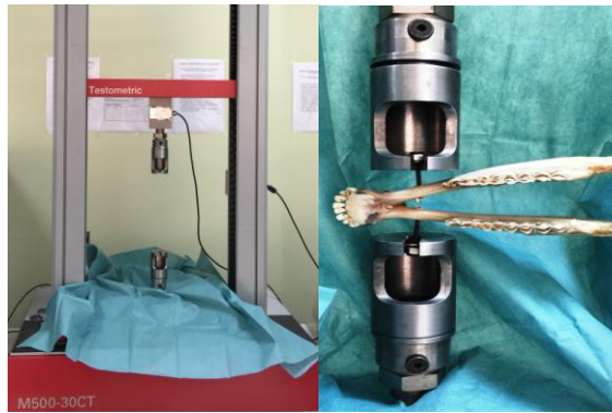
Resim-6: Testometric M500 30 kn gerilim cihazı ve mandibula modellerinin servohidrolik test ünitesine tespiti.
