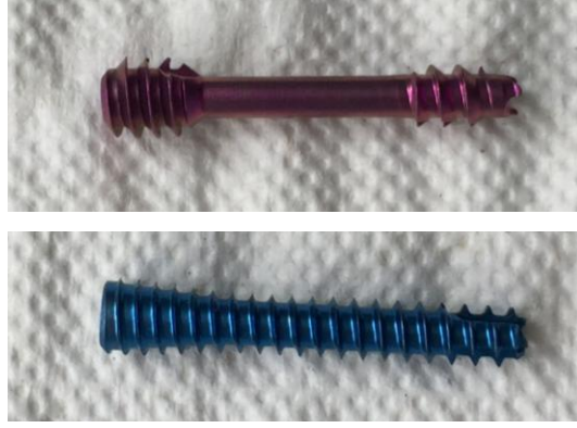
Resim-3: Herbert Vidası ve HCCS Vidası. (Üstte, orta 1/3'lük şaft kısmında yiv içermeyen Herbert vidası (3,0 mm tail, 2.0 mm şaft, 2.5 mm apeks çapı, 20 mm uzunluk) ve altta konik yapıllı tümüyle yivli HCCS vidası (2,8 mm tail, 2.5 mm şaft, 2,5 mm apeks çapı, 20 mm uzunluk).
