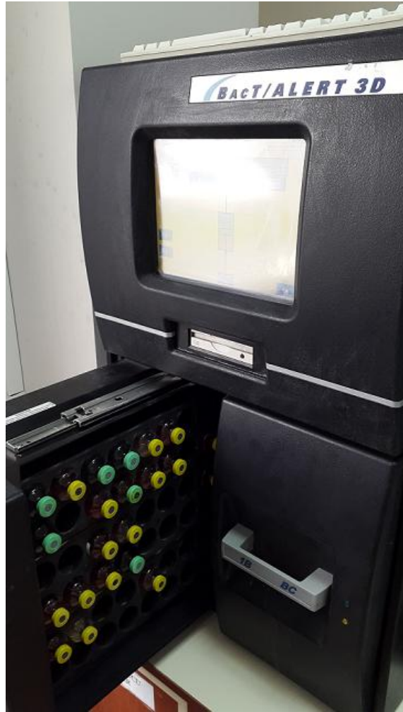
Şekil 21. Kan kültür şişelerinin konulduğu kan kültür cihazı
