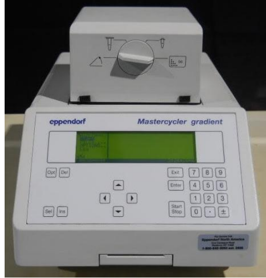
Şekil 3.15 PCR işlemlerinin gerçekleştirildiği Thermocycler (Eppendorf Mastercycler Gradient) cihazı.
