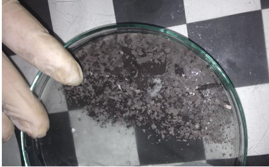
Şekil 3.33: Asit liçinden sonra membran filtreden süzölmüş toz ürün.
