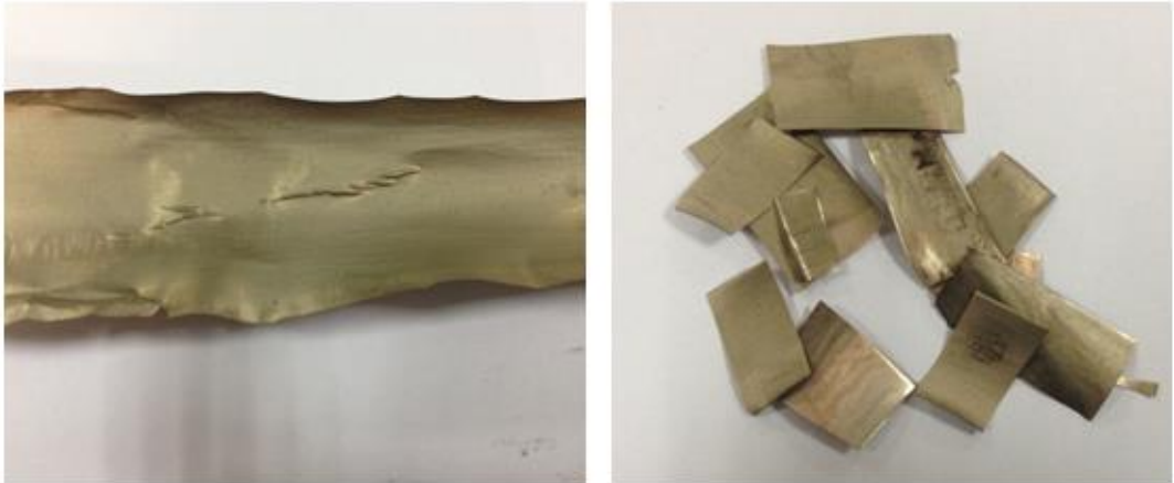
Şekil 3.37: \text{NbCl}_5\text{-BCl}_3\text{-H}_2 sisteminde CVD işleminden sonra reaktörden çıkarılmış üstü kaplı bakır.
