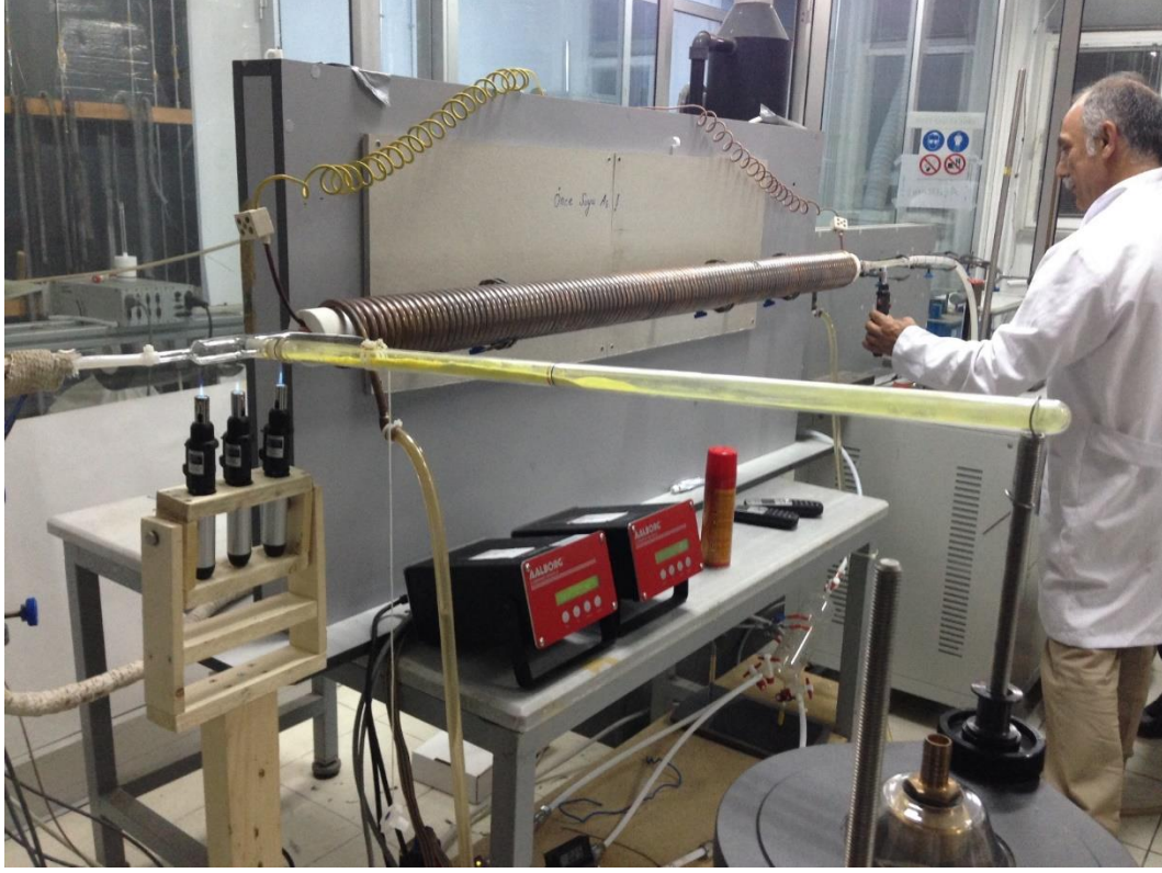
řekil 3.16: Tuz gazlařtırma amacıyla kurulan vibratörlü ve řalümler ısıtmalı düzenek.
