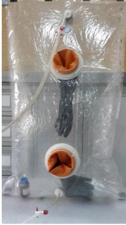
Őekil 3.15: Ar altında tuzları t p iine doldurmaya yarayan, labaratuvarda imal edilmiő kapalı ortam torbası.
