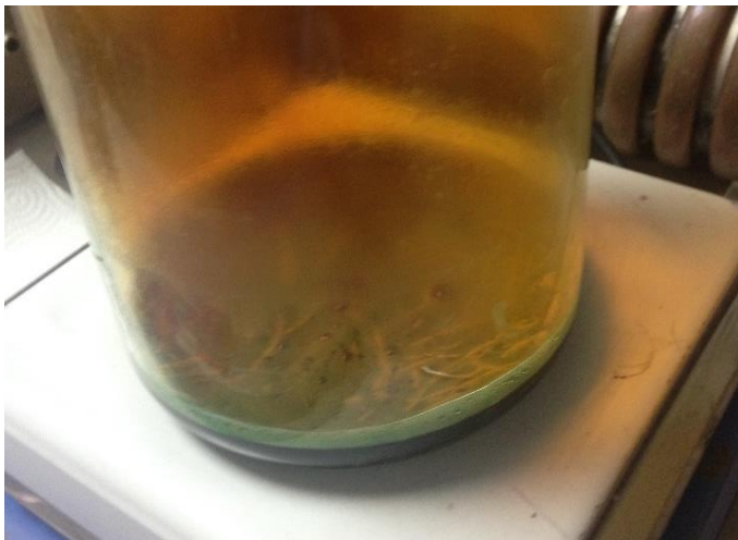
Şekil 4.9: Sıcak nitrik asit içinde çözünmekte olan kapiler borucuklar halindeki kaplamalar.
