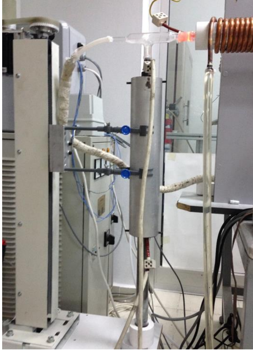
Şekil 3.14: Step motorla hareket ettirilen ısıtma ünitesi
