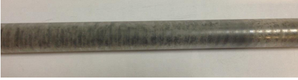
Şekil 4.8: ZrCl_4-BCl_3-H_2 sisteminde tohumlama deneyi sonrası reaktör iç tüpünün görüntüsü.
