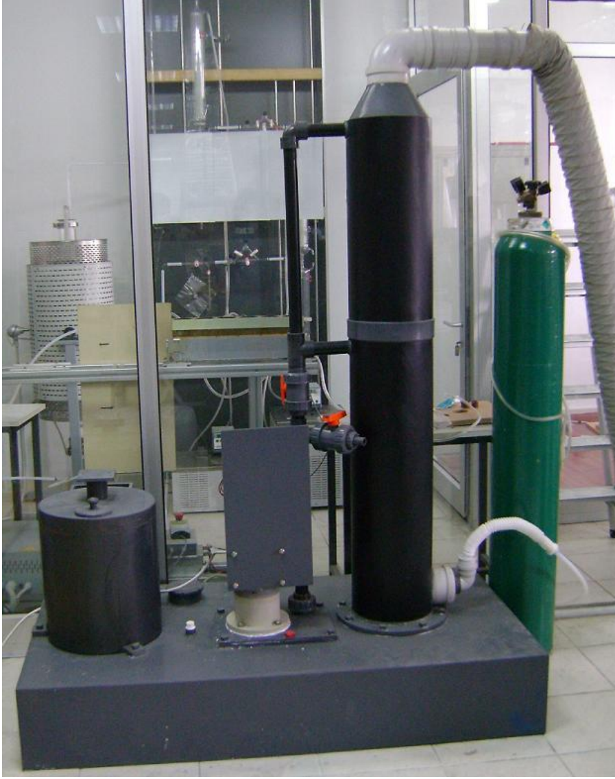
Şekil 3.27: Gaz yıkama kulesi.
