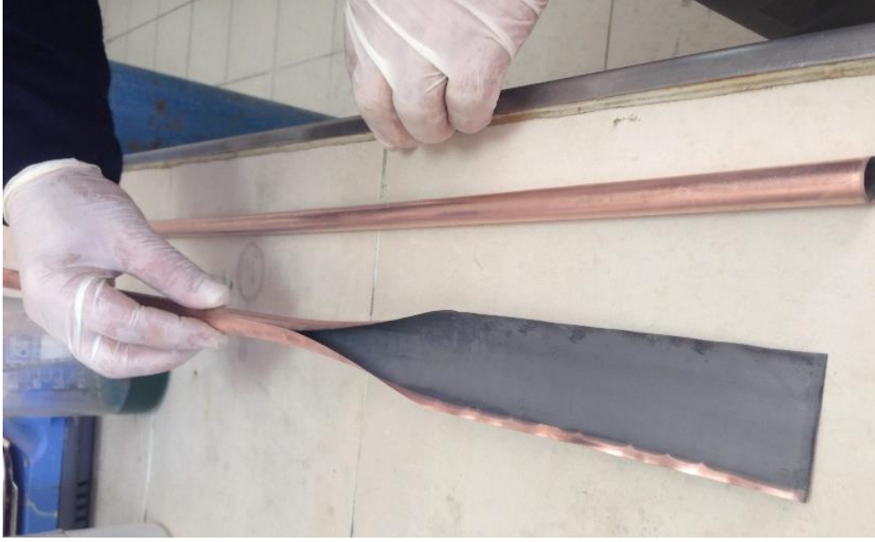
Şekil 3.31: ZrCl_4-BCl_3-H_2 sisteminde CVD işleminden sonra kuvars tüp içinden çıkarılan bakır altlıklar.
