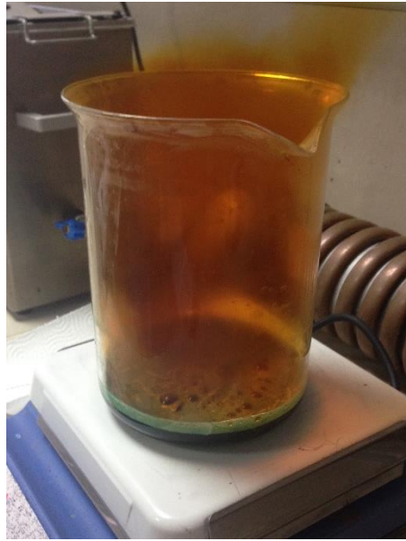
Şekil 3.30: Bakır tellerin sıcak nitrik asit liçi.
