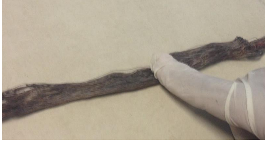
Şekil 3.29: 1.5 m'lik kuvars tüpten çıkarılan çok ince ZrB 2 kaplanmış bakır tel demeti.
