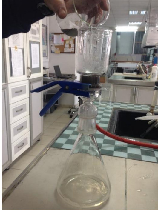
Şekil 3.34: Çok ince partikülleride rahatça tutabilen membran filtre seti.
