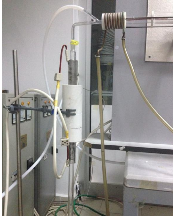
Şekil 3.12: Kuvvars tüp içerisindeki metal klorür tozlarının dıştan sarılmış direnç teli vasıtasıyla ısıtılarak reaktöre beslendiği ünite.
