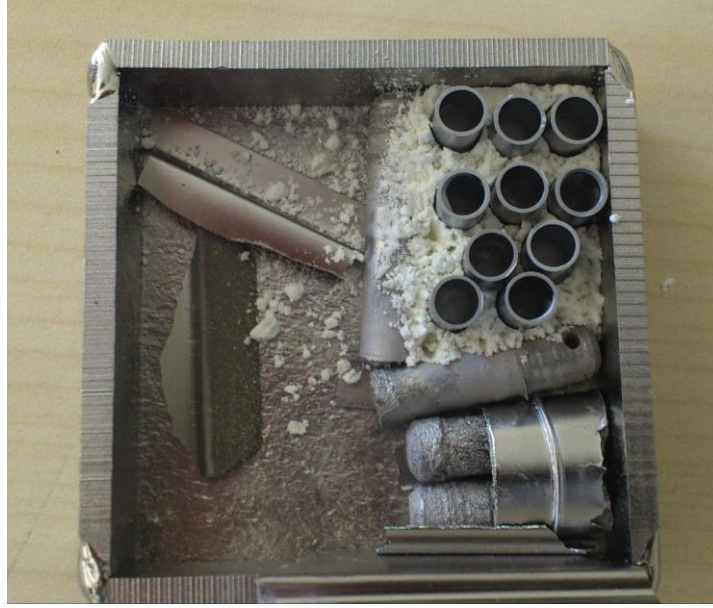
Şekil 5.17 Oksit tozlara ( BaO , CaO , Al_2O_3 ) daldırılmış katotlar
