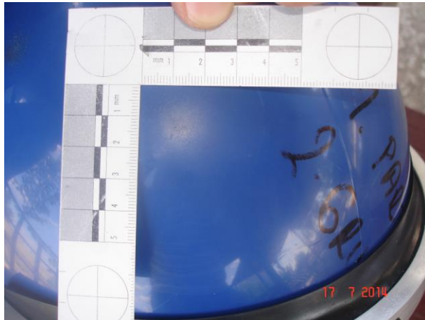
Resim 4.43. Polis çevik kuvvet başlığı gövdesine 4 cm'den atış sonucu meydana gelen harabiyet
