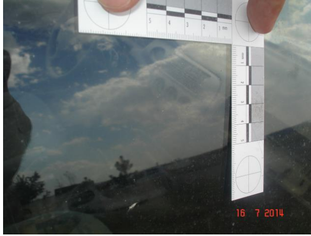
Resim 4.82. Otomobil yan camına 4 cm mesafeden yapılan atışın görünümü
