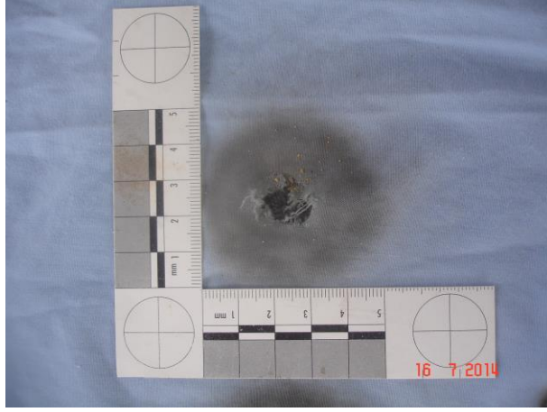
Resim 4.20. Polis gömleğine 2 cm'den atış sonucu meydana gelen harabiyet
