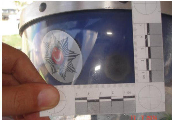
Resim 4.47. Polis çevik kuvvet başlığı vizörüne 1 cm'den atış sonucu meydana gelen harabiyet
