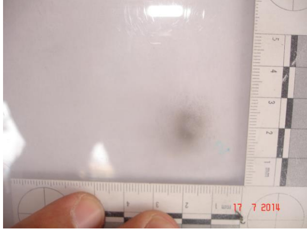
Resim 4.62. Polis çevik kuvvet kalkanına 2 cm mesafeden yapılan atışın görünümü
