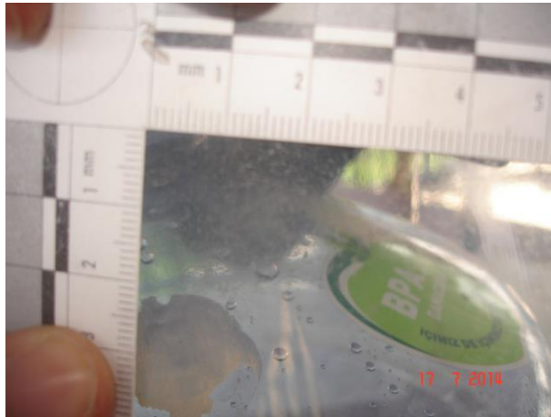
Resim 4.56. Polis evik kuvvet bařlıđı vizrne 3 cm'den atıř sonucu meydana gelen harabiyet
