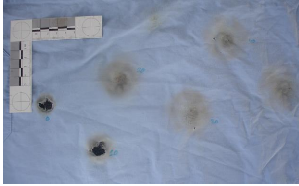
Resim 4.31. Polis gömleğine 0-5 cm'den yapılan 6 atışın bir arada görünümü
