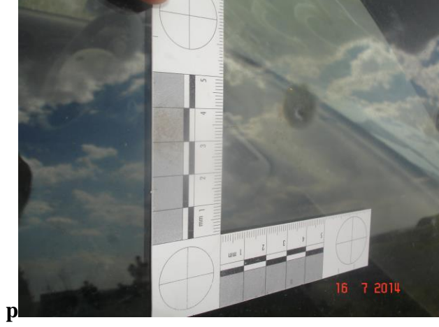
Resim 4.79. Otomobil yan camına 1 cm mesafeden yapılan atışın görünümü
