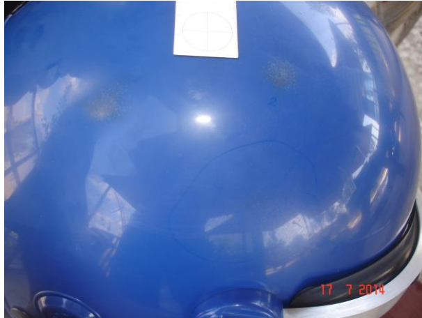
Resim 4.45. Polis çevik kuvvet başlığı gövdesine 0-5 cm'den yapılan 6 atışın bir arada görünümü
