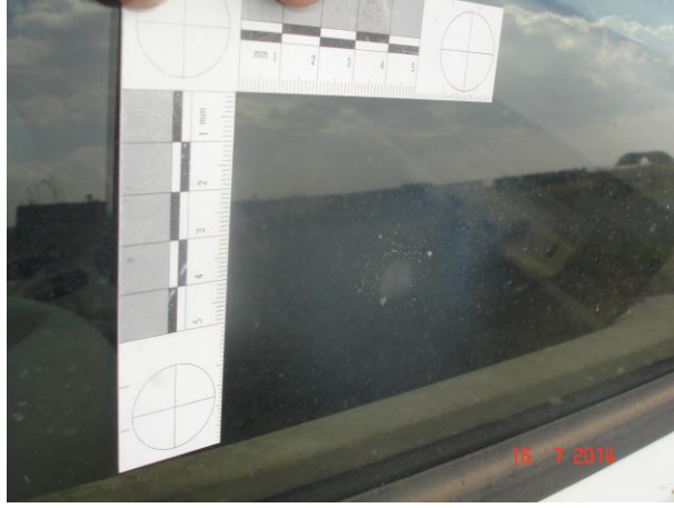
Resim 4.77. Otomobil yan camına 5 cm mesafeden yapılan atışın görünümü
