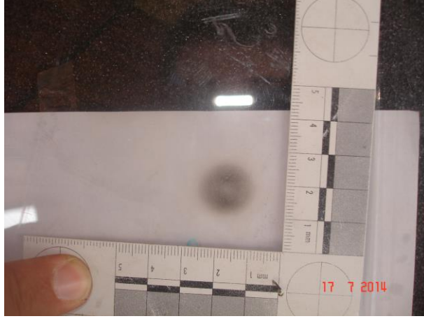
Resim 4.60. Polis çevik kuvvet kalkanına 0 cm mesafeden yapılan atışın görünümü
