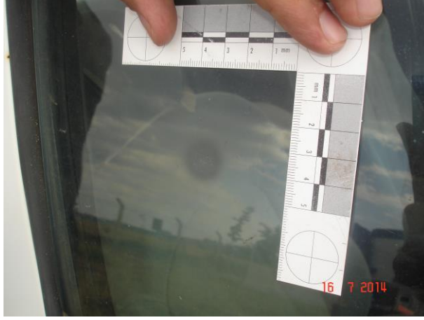
Resim 4.73. Otomobil yan camına 1 cm mesafeden yapılan atışın görünümü
