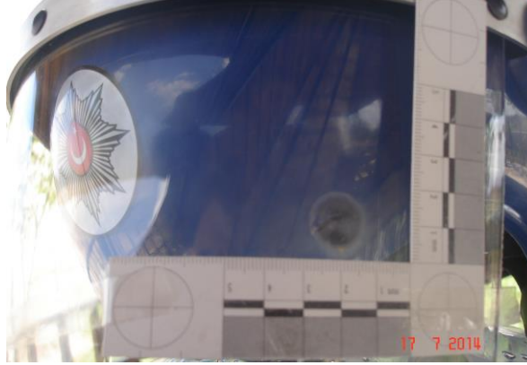
Resim 4.46. Polis çevik kuvvet başlığı vizörüne 0 cm'den atış sonucu meydana gelen harabiyet
