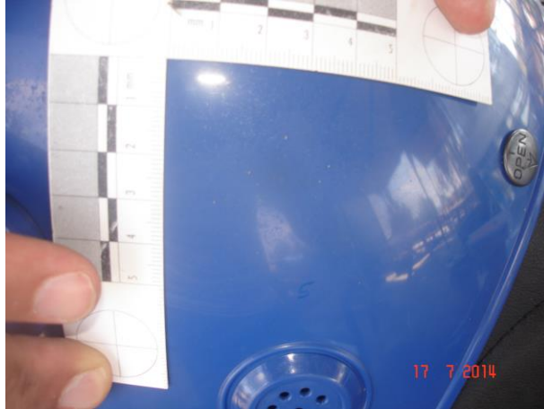
Resim 4.37. Polis çevik kuvvet başlığı gövdesine 5 cm'den atış sonucu meydana gelen harabiyet
