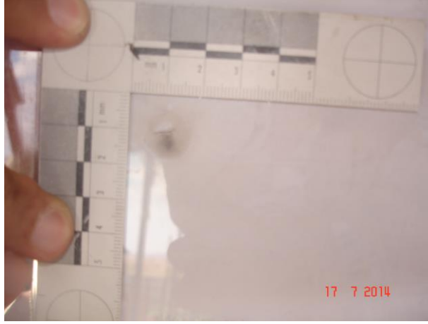
Resim 4.66. Polis çevik kuvvet kalkanına 0 cm mesafeden yapılan atışın görünümü
