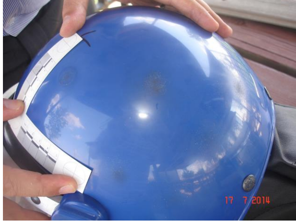
Resim 4.38. Polis çevik kuvvet başlığı gövdesine 0-5 cm'den yapılan 6 atışın bir arada görünümü
