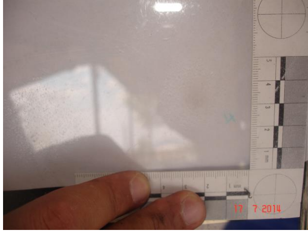
Resim 4.64. Polis çevik kuvvet kalkanına 4 cm mesafeden yapılan atışın görünümü
