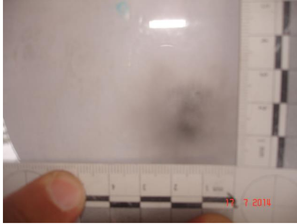
Resim 4.61. Polis çevik kuvvet kalkanına 1 cm mesafeden yapılan atışın görünümü
