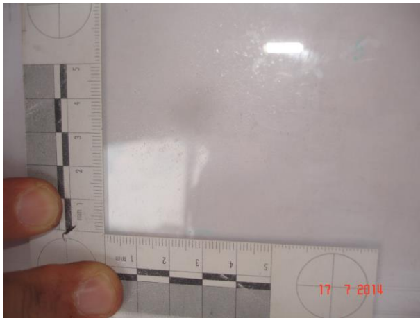
Resim 4.71. Polis çekik kuvvet kalkanına 5 cm mesafeden yapılan atışın görünümü
