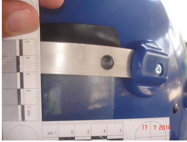
Resim 4.50. Polis çevik kuvvet başlığı vizörüne 4 cm'den atış sonucu meydana gelen harabiyet
