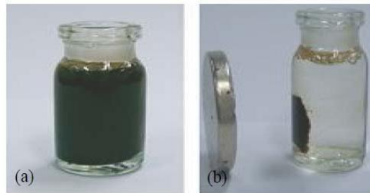
Şekil.1.33. Manyetik Fe_3O_4 nanopartiküller a) manyetik alan olmadığı durum b) manyetik alan altında olduğu durum
