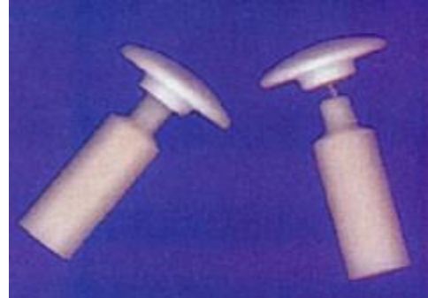
Şekil 3.3 Kulak implantı olarak kullanılan hidroksiapatit vidalar [16]
