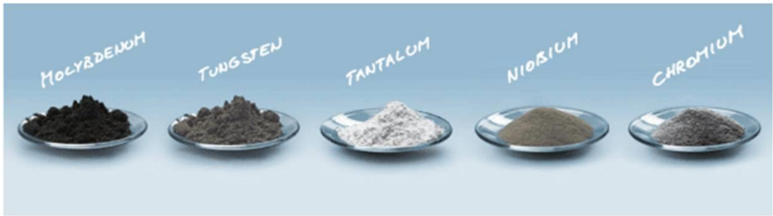
Şekil 1.6 Kesici takım imalatında kullanılan metal tozları [17]
