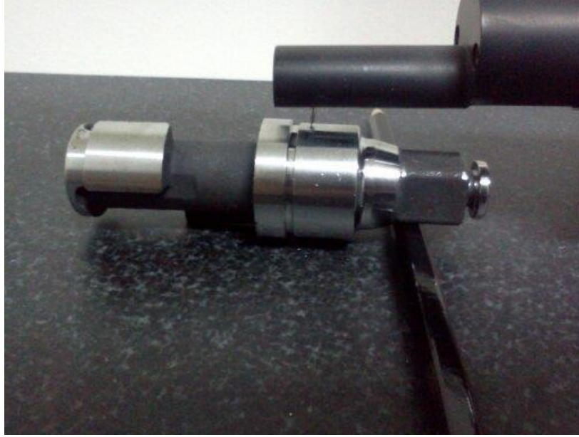
Şekil 4.16 Mahr Perthometer S2 cihazı ile numunenin yüzey ölçümü
