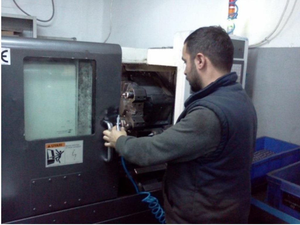
Şekil 4.2 Numunelerin Piksan CNC Firması'nda ön talaşlı şekillendirilmesi [48]
