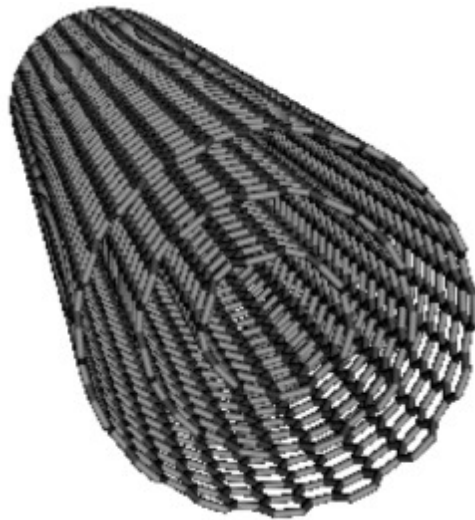
Şekil 2.10. Çok duvarlı karbon nanotüp [21]
