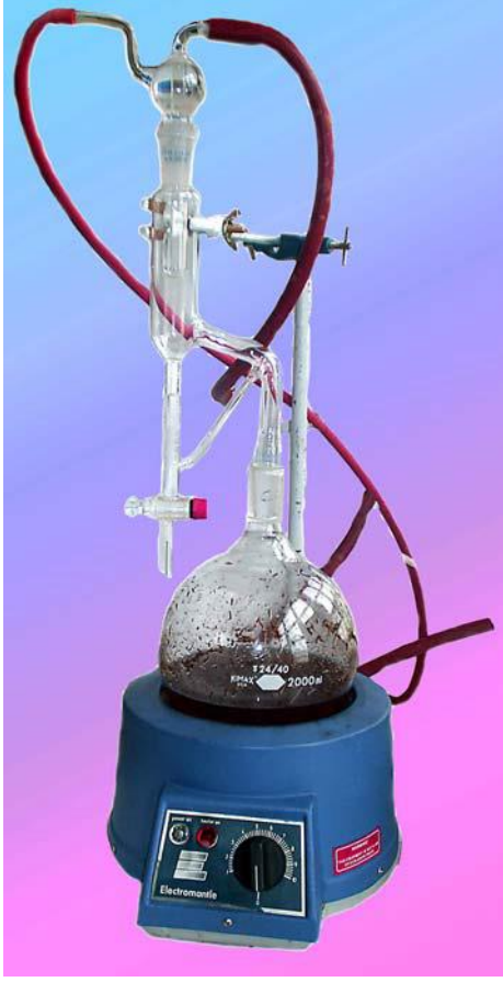
Şekil 2.3. Clevenger tipi subuharı destilasyon düzeneği
