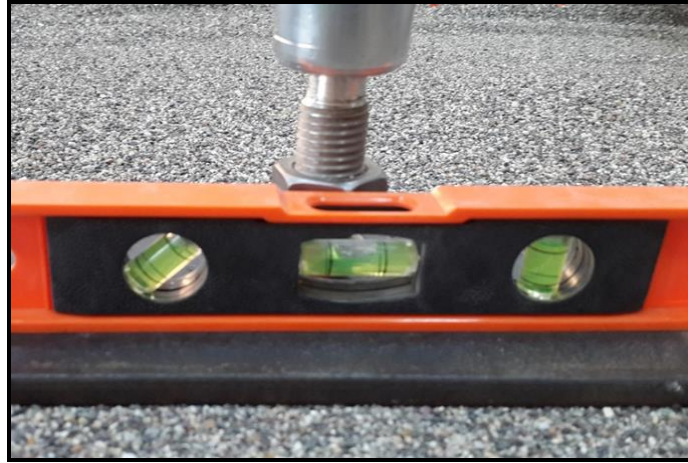
10cmx30cm model temelde yük e/L=0 durumunda (merkez yükleme) yükleme düzeneği
