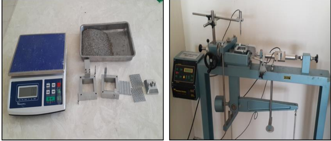
řekil 3.11. Kesme kutusu deney dzeneęi
