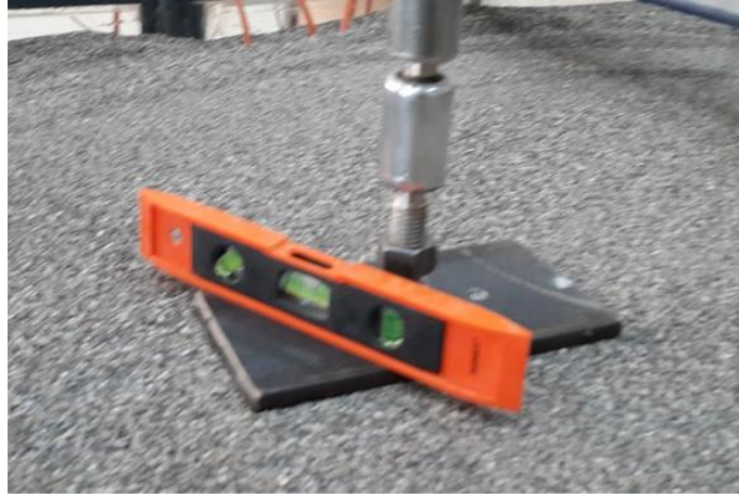
10cmx20cm model temelde yük e/B=0 durumunda (merkez yükleme) yükleme düzeneği
