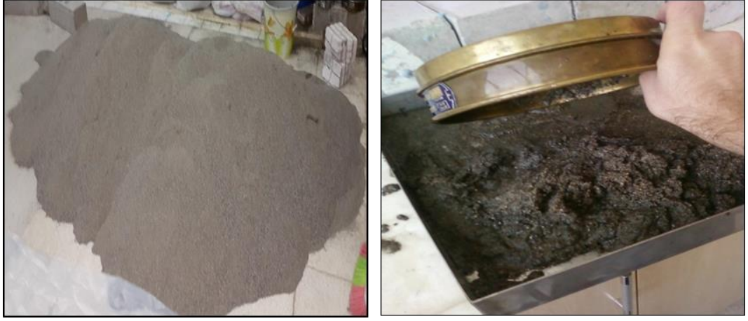
Şekil 3.3. Deney kumunun yıkanması
