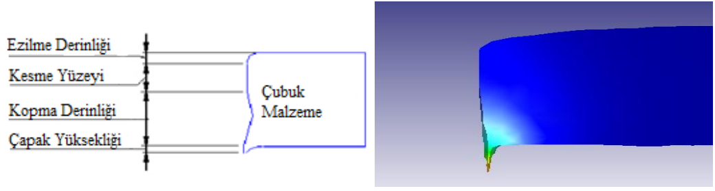
Şekil 1.2. Kesilen çubuk malzemenin geometrisi
