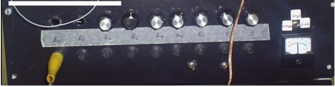
Şekil 3.9 Elektron tabancası kontrol ünitesi.
