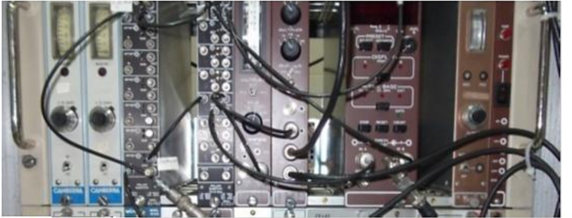
Dedektör Güç Birimleri Yükseltici Ayırıcı Zaman-Genlik Dönüştürücü Sayıcı ve Zamanlayıcı Dedektör Gerilim Besleme Güç Kaynağı
