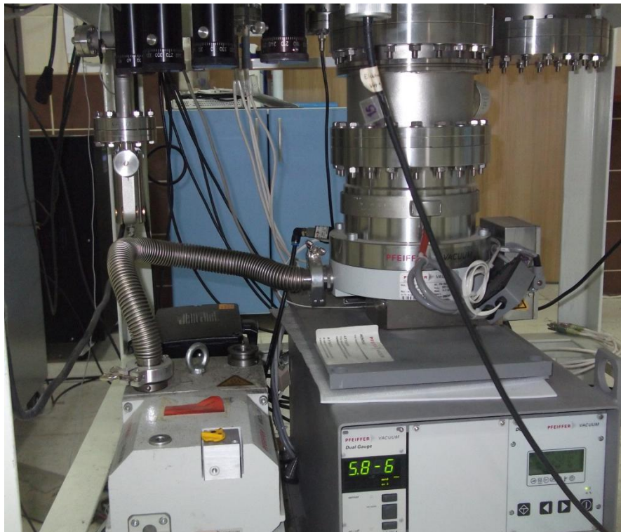
Şekil 3.4 Turbo moleküler ve mekanik pompalar, basınç ölçüm-görüntüleme cihazları ve baęlantılarının birlikte bulunduęu istasyonun yakından görünümü.
