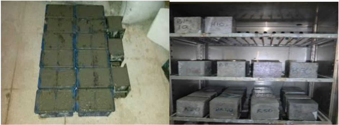
Şekil 3.9. Üretilen 100x100x100 mm beton numuneleri
