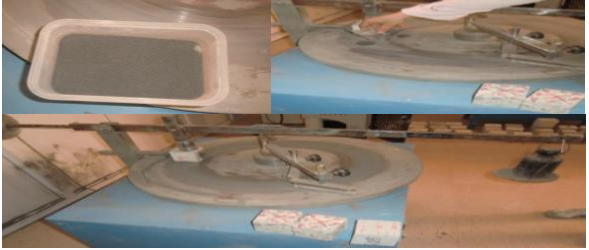
Şekil 3.15. Böhme deney aleti, numune ve zımpara tozu
