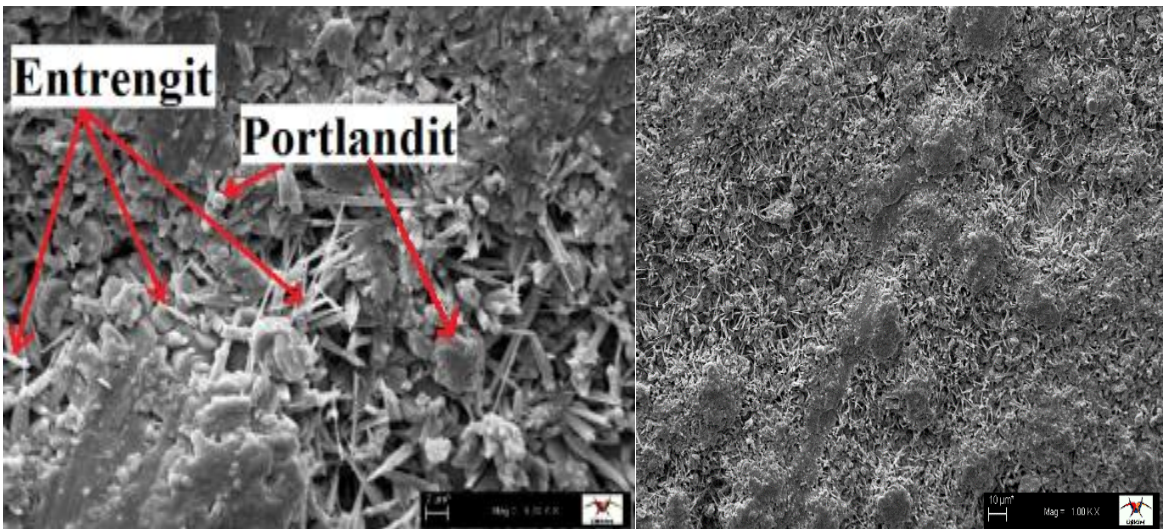
Şekil 4.44. Y50 numunesinin sülfat sonrası sem görüntüsü
