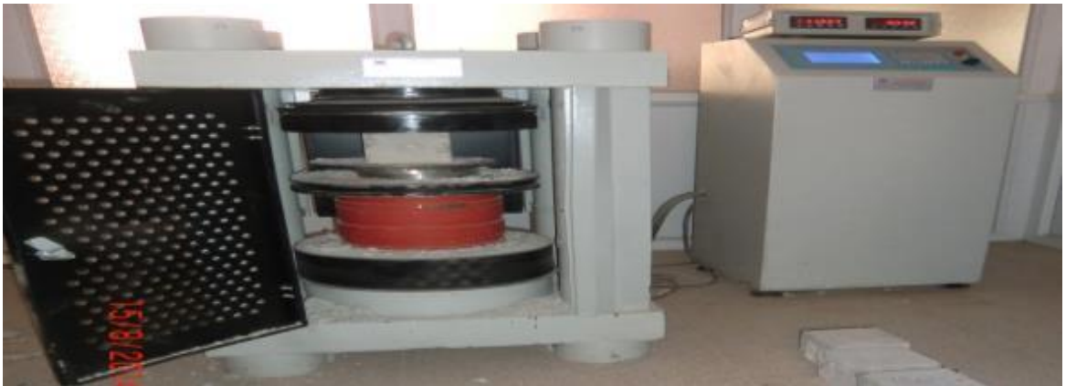
Şekil 3.10. Basınç presi ve deney anından görüntü
