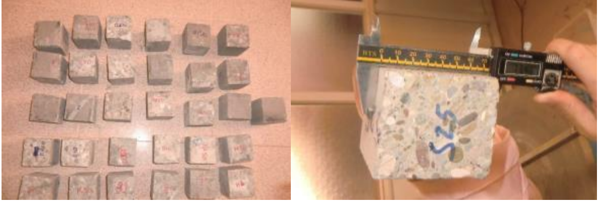
Şekil 3.14. Beton numuneler ve beton numunelerin boyutlarının ölçümü
