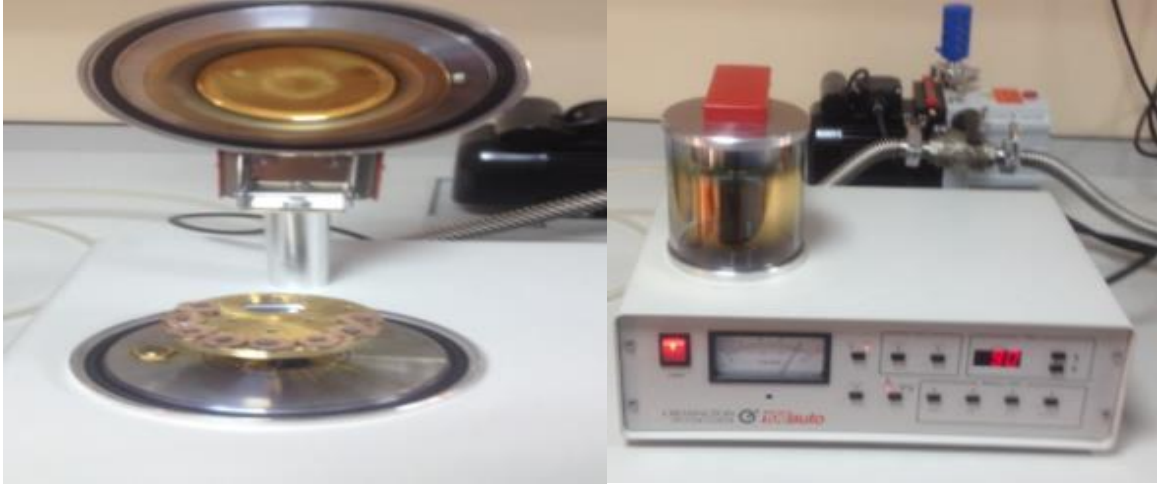
Şekil 3.19. Altın kaplama işlemi
