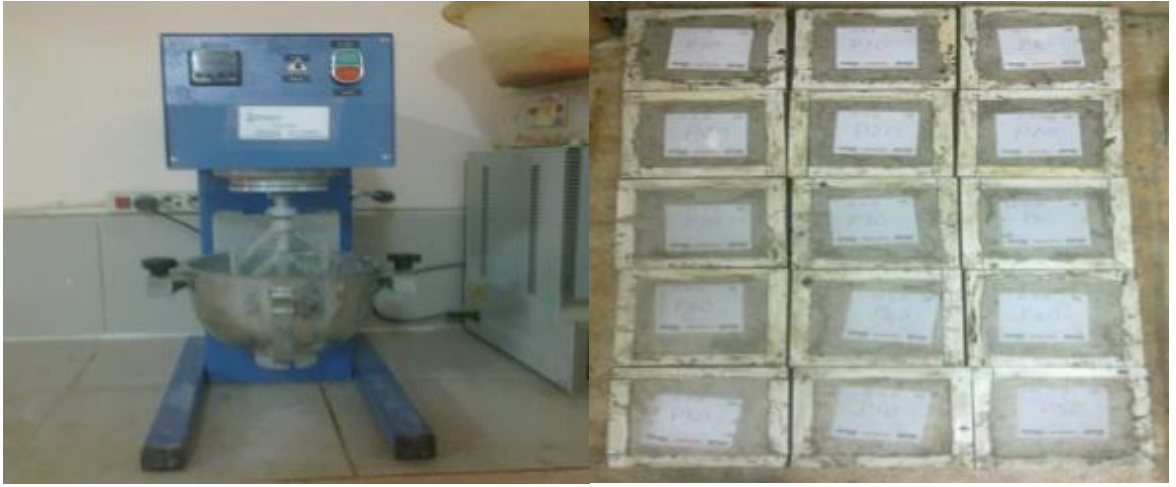
Şekil 3.7. Harç numunelerinin karıştırılması ve kalıplara dökülmesi
