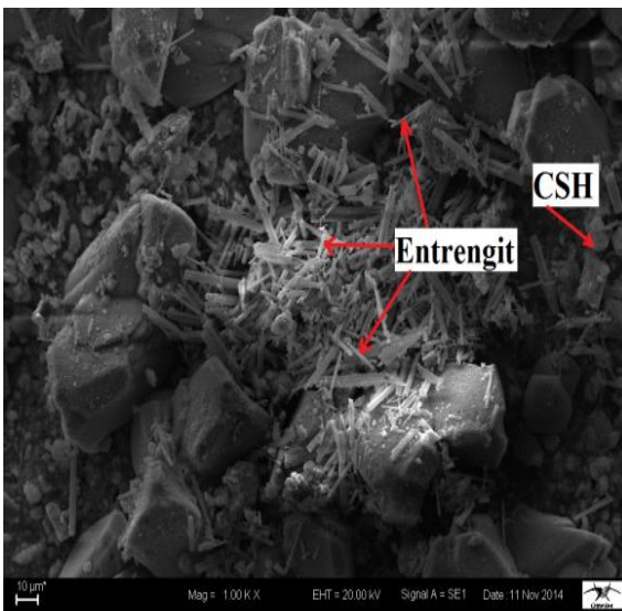
Şekil 4.47. BP50 numunesinin sülfat sonrası sem görüntüsü
