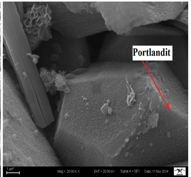
Şekil 4.57. D10 numunesinin sülfat sonrası sem görüntüsü
