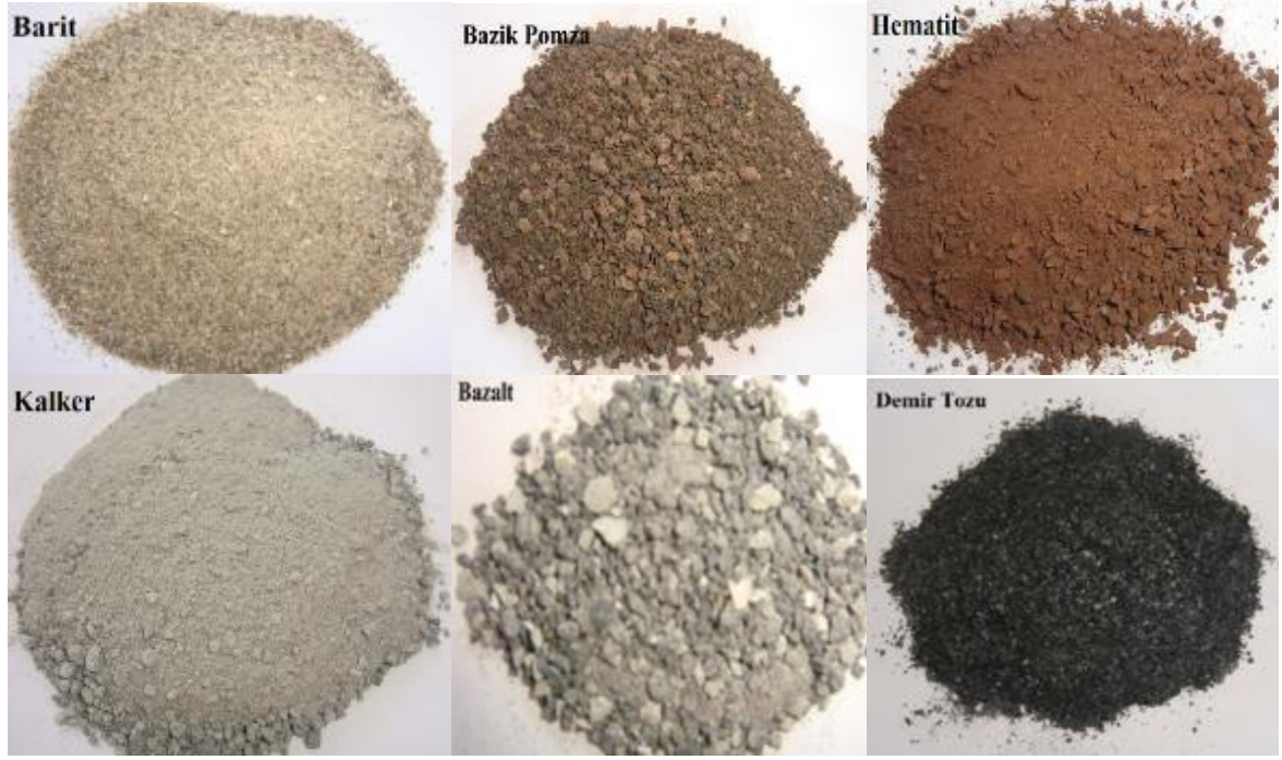
Şekil 3.3. Deneysel çalışmada kullanılan barit, pomza, kalker, hematit, bazalt ve demir tozu
