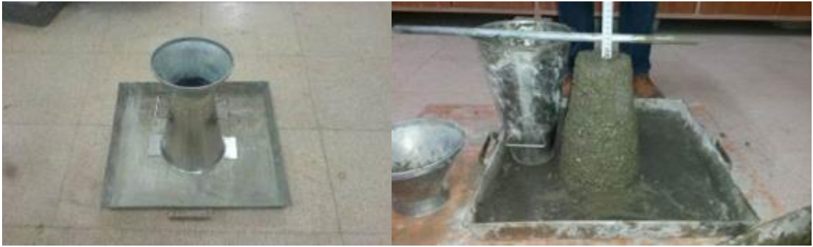
Şekil 3.6. Deney aletleri ve slump deneyi
