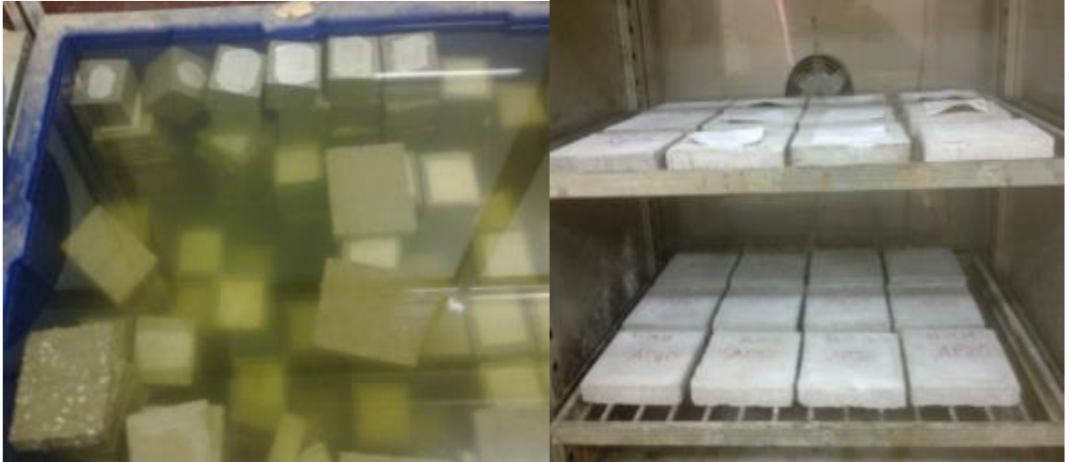
Şekil 3.8. Harç numunelerinin kür havuzunda beklemesi ve etüve bırakılması
