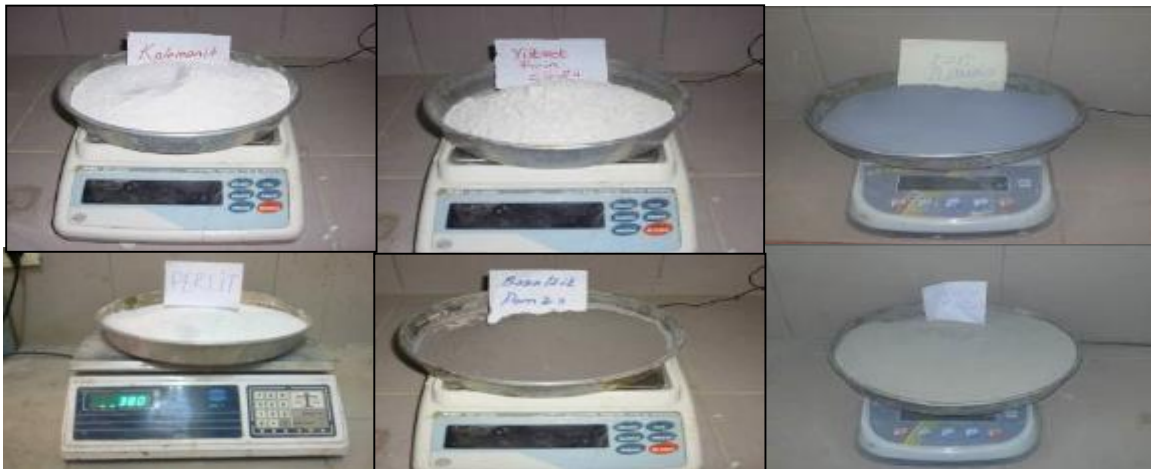
Şekil 3.2. Deneysel çalışmada kullanılan kolemanit, yüksek fırın cürufu, silis dumanı, perlit, bazaltik pomza, uçucu kül
