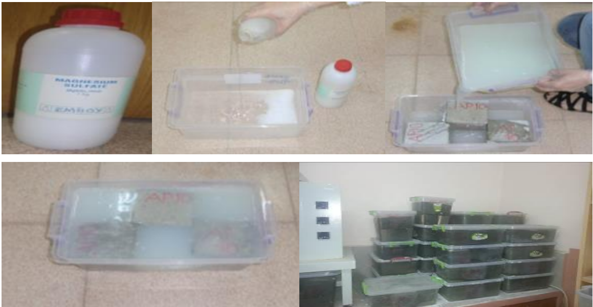
Şekil 3.13. %10 MgSO 4 çözeltisinde bekletilen beton numuneleri
