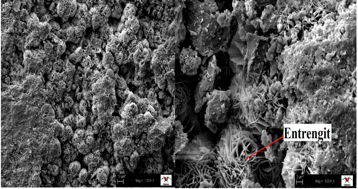
Şekil 4.37. P15 numunesinin sülfat sonrası sem görüntüsü
