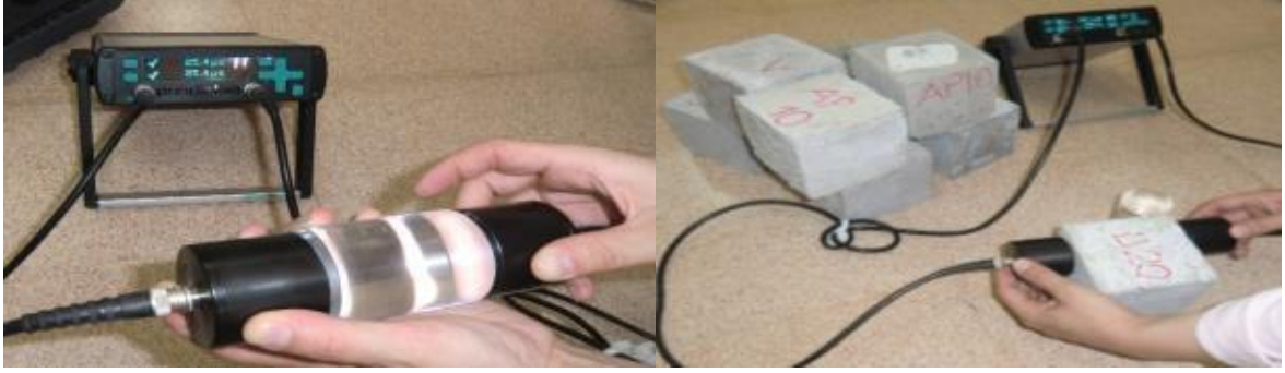
Şekil 3.12. Ultrases cihazı ve deneyin yapılışı
