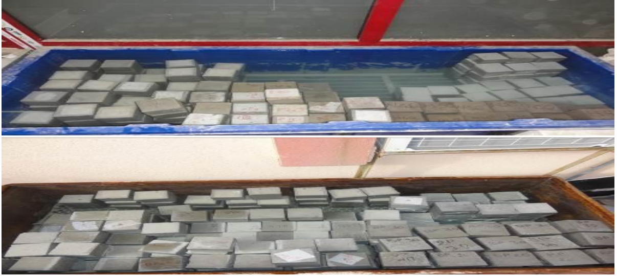
Şekil 3.5. Numunelerin saklandığı kür havuzu
