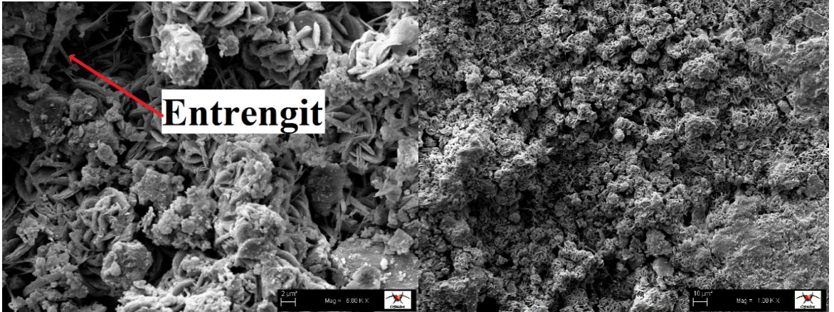
Şekil 4.41. U30 numunesinin sülfat sonrası sem görüntüsü
