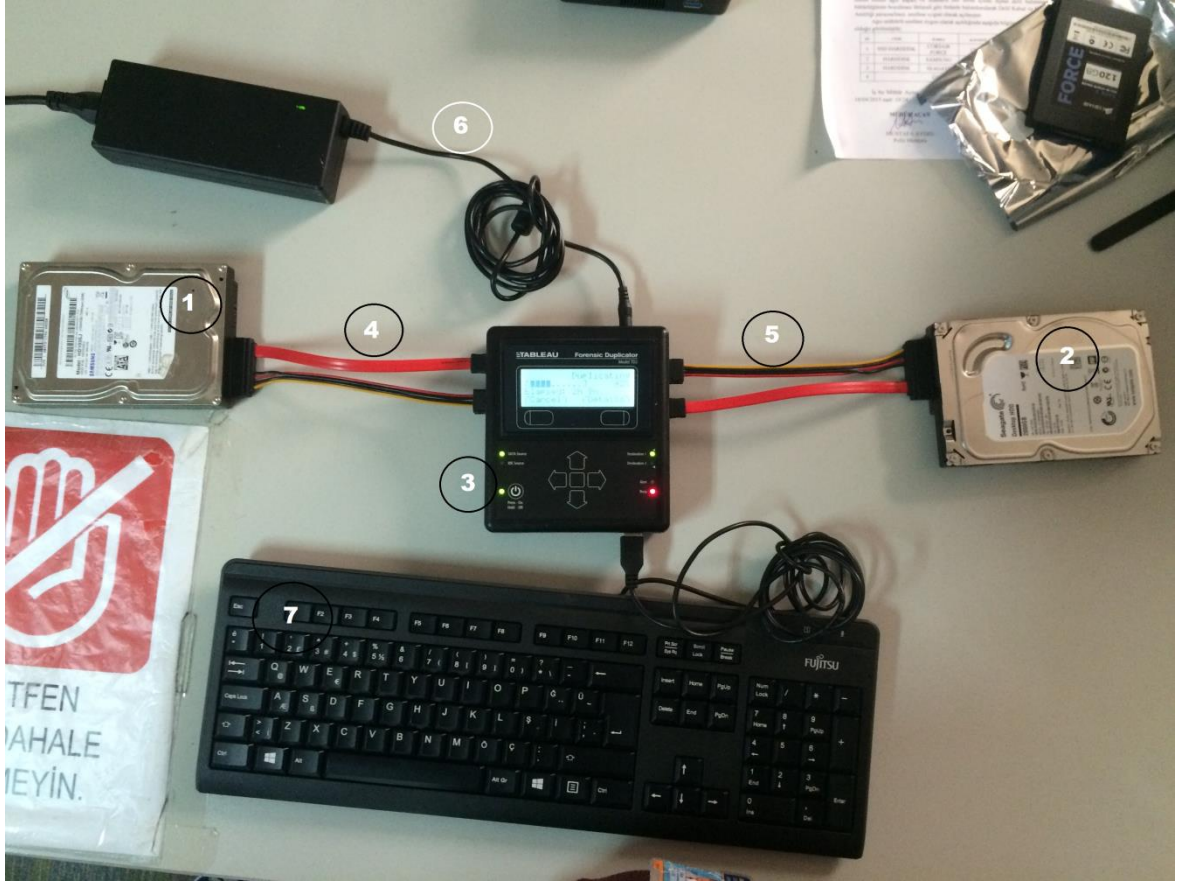
Resim 4.1. Kopya Alma İşlemi Tableau TD1 (Disk Adli Kopyalama Cihazı)
