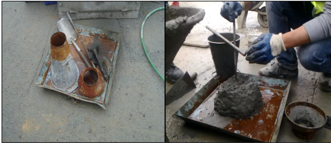
Fotoğraf 4.2. Çökme (slump) deneyi
