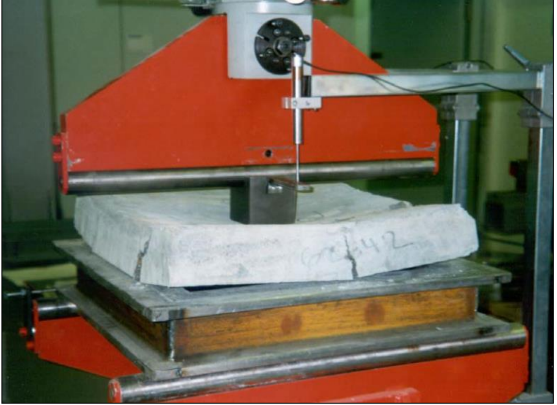
Fotoğraf 3.4. Fransız (efnarc) plak testi deney düzeneği
