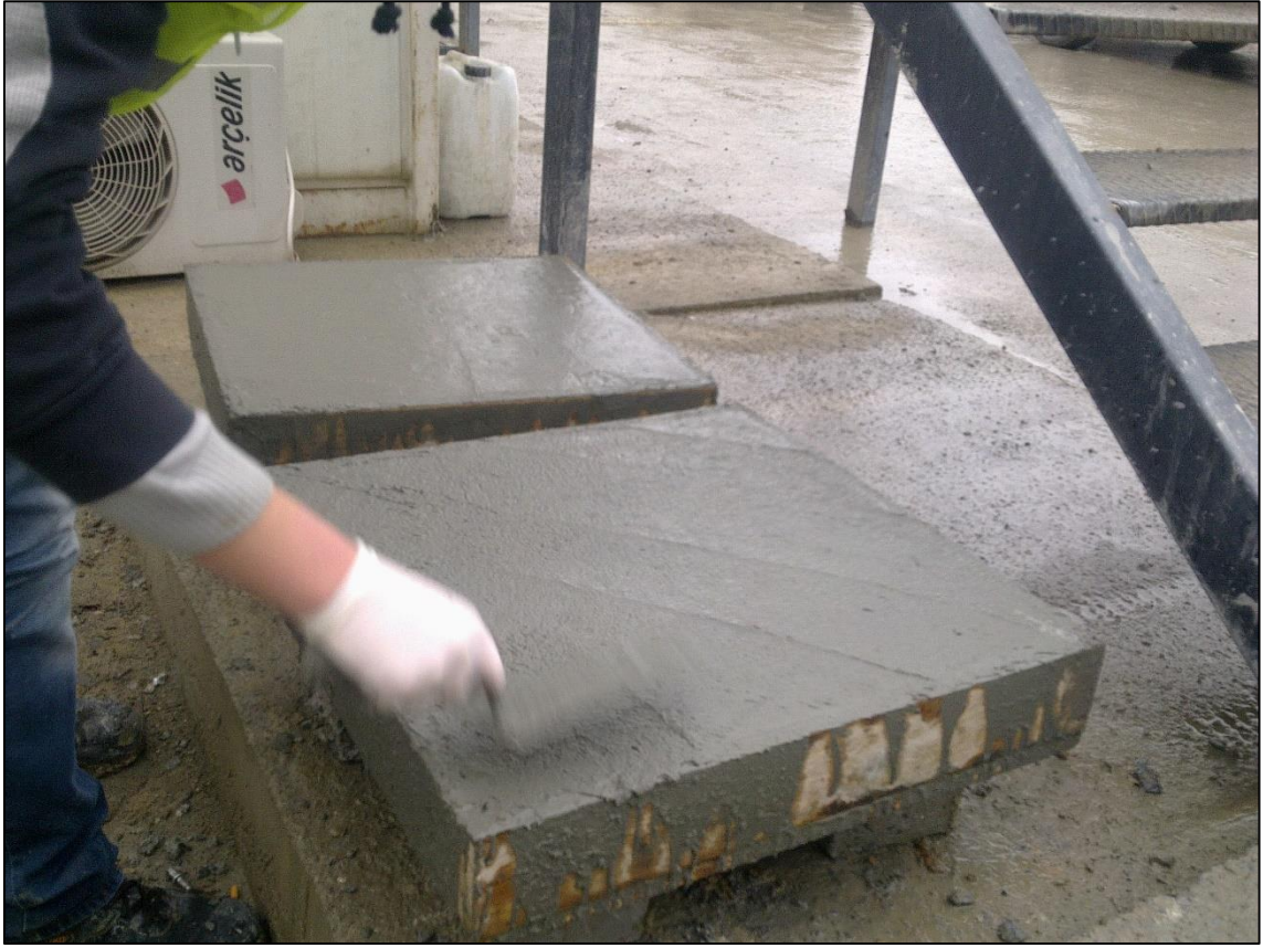
Fotoğraf 4.1. Plak numunelerinin perdahlanması
