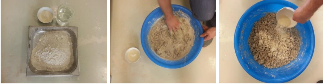
Şekil 3.9. Atık kil/bentonit karışımlarının hazırlanması
