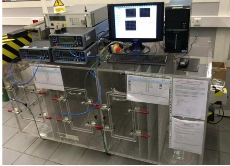
Şekil 4.3 AMCA 210- 07 Standartlarına göre hazırlanmış rüzgar tüneli
