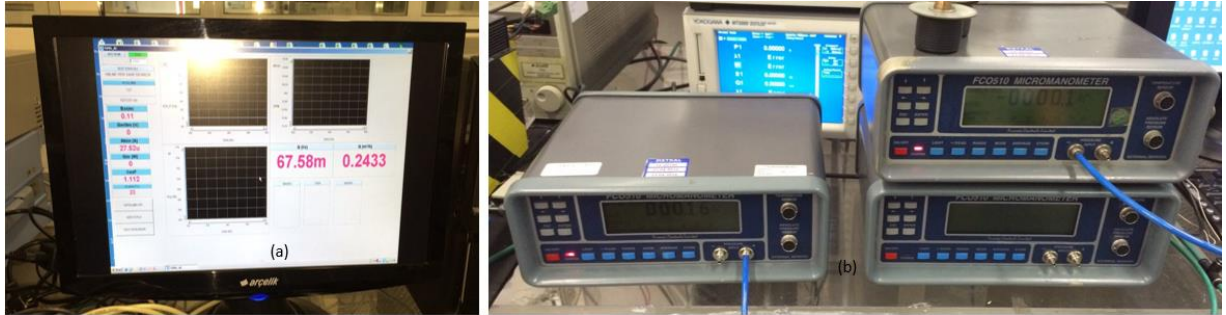
Şekil 4.6 (a) Rüzgar tüneline bağlı basınç ve debi değerlerini toplayan bilgisayar (b) rüzgar tüneline bağlı manometreler
