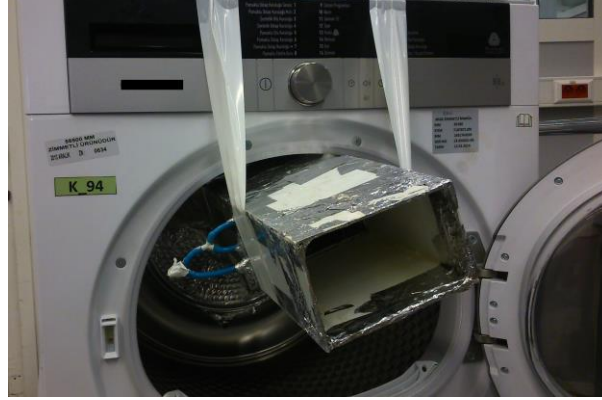
Şekil 4.5 Kurutucunun üfleme ağzının rüzgar tüneline bağlanması
