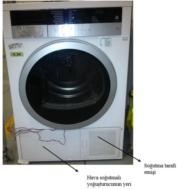
Şekil 4.4 Deneylerde kullanılan kurutucunun genel görünümü ve hava soğutmalı yoğuşturucunun yeri
