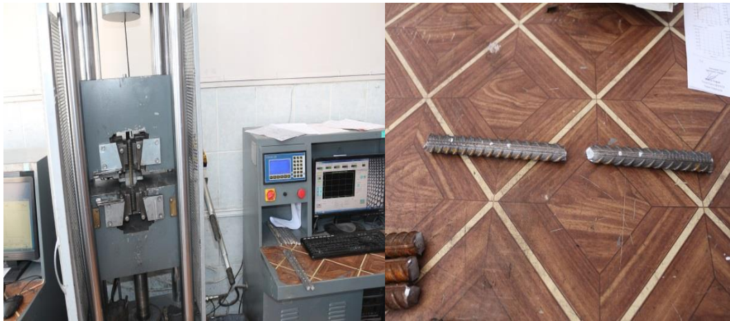
Şekil 3.6: Ankraj donatı testlerine ait görüntüler.
