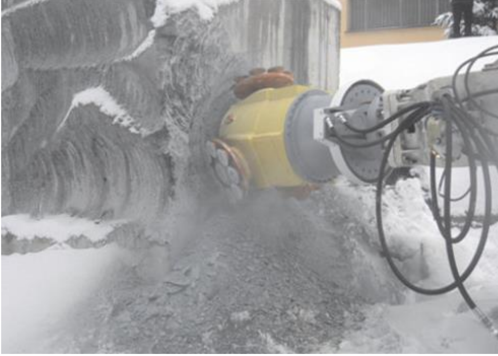
Şekil 3.33 : Asimetrik kafanın betonda test edilmesi [41].
