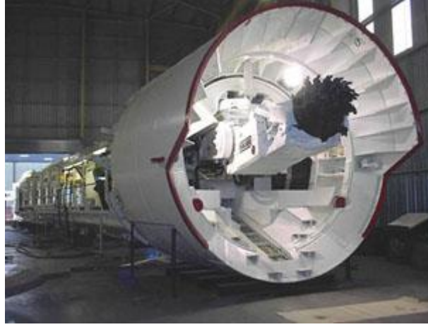
Şekil 3.2 : Kalkanlı bomlu kazı makinası.
