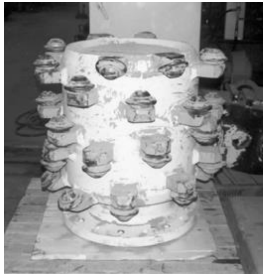
Şekil 5.5 : Mini-diskli modifiye kesici kafa [41].
