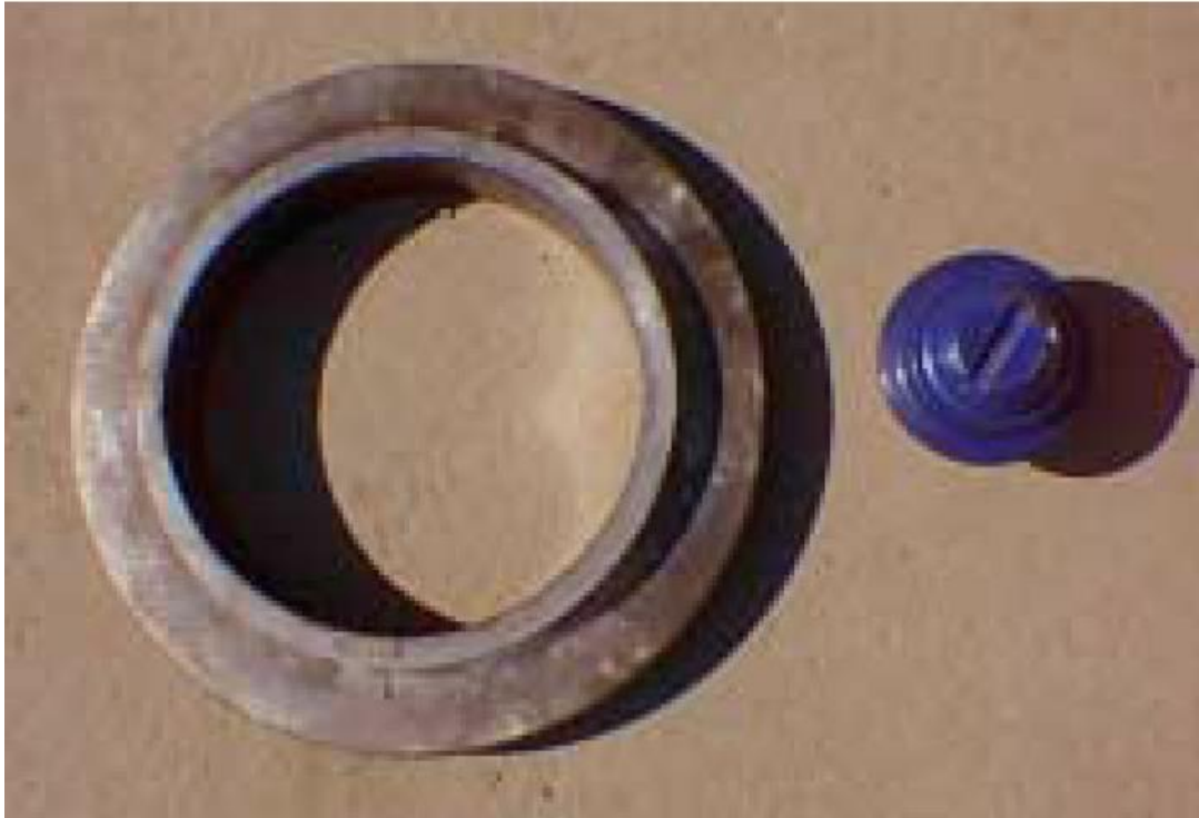
Şekil 5.1 : 17 inçlik disk keski (solda) ve 5 inçlik mini-disk keski [45].
