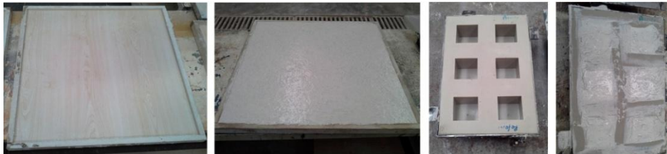
Şekil 4.5 Tipik panel, küp numune kalıp formları ve yerleştirilmiş durum
