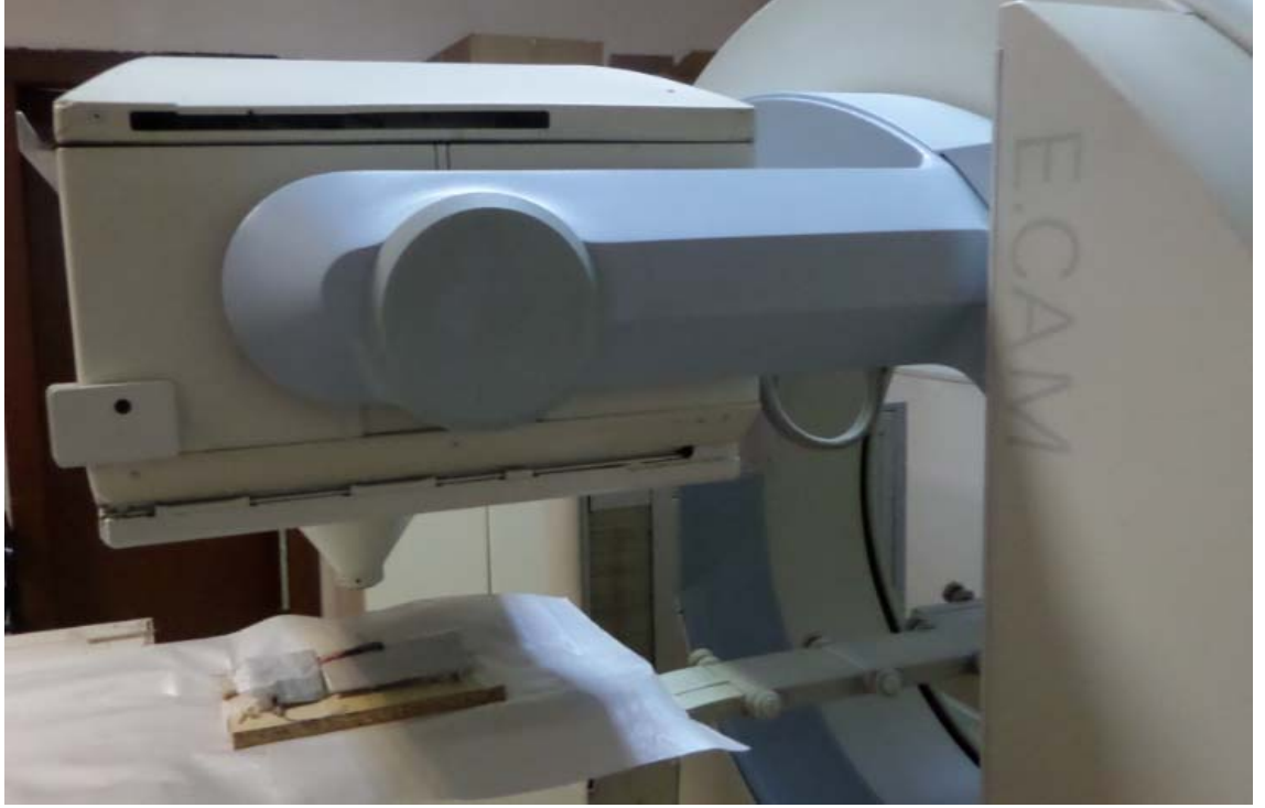
Resim 3.10: Gama kamera altında pinhole kolimatör kullanılarak sintigrafi çekimi
