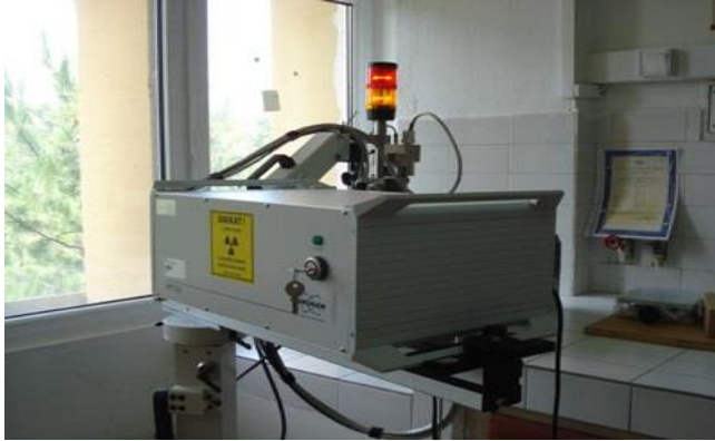
Resim 3.11. Enerji Dağılımlı Portatif \mu -XRF Spektrometresi (İnternet : http://www.taek.gov.tr/kurumsal/birimler/bagli-kuruluslar/sanaem/191-radyoaktivite-ve-analitik-olcum-bolumu.html )
