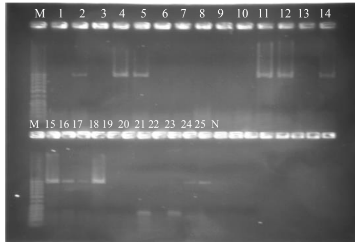
Figure 39 Gel photograph for int1 gene in 1: MET S1-88 (-), 2: MET S1-92 (+), 3: MET S1-103 (-), 4: MET S1-142 (+), 5: MET S1-329 (+), 6: MET S1-345 (-), 7: MET S1-351 (-), 8: MET S1-492 (-), 9: MET S1-498 (-), 10: MET S1-510 (-), 11: MET S1-597 (+), 12: MET S1-606 (+), 13: MET S1-668 (-), 14: MET S1-669 (+), 15: MET S1-671 (+), 16: MET S1-672 (+), 17: MET S1-673 (+), 18: MET S1-674 (+), 19: MET S1-87 (-), 20: MET S1-313 (-), 21: MET S1-405 (+), 22: MET S1-542 (-), 23: MET S1-660 (+), 24: MET S1-24 (+), 25: MET S1-31 (+), 26(N): Negative control, M: GeneRuler 50 bp DNA ladder as marker
