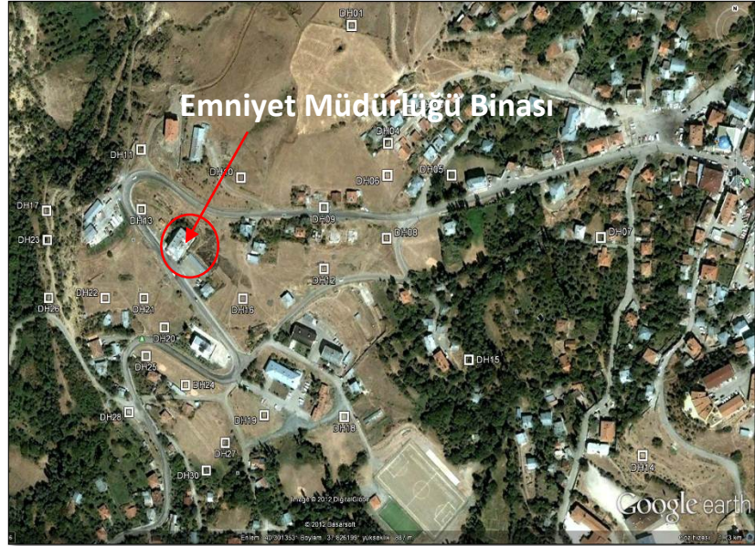
Şekil 4.6 Emniyet Müdürlüğü binası civarındaki 50 m aralıklarla tesis edilen GPS noktaları.
