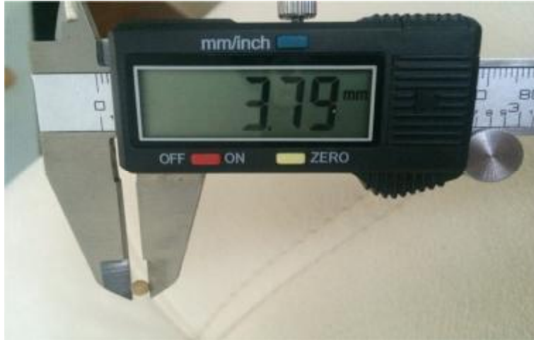
Şekil 3.25. Kumpasla Crambe meyvesinin çap ölçümü
