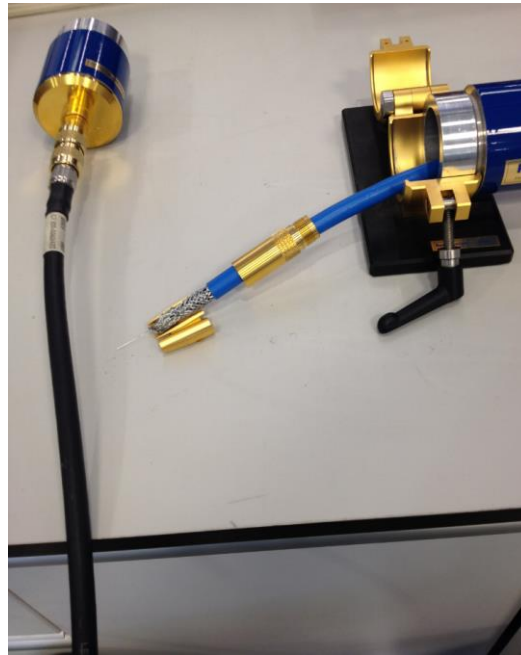
Şekil 3.18 Kablonun giriş ucunun hazır hale getirilmesi
