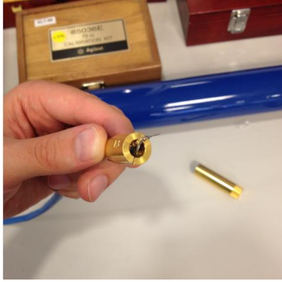
Şekil 3.10 Aparat ile sabitleştirilmiş kablo ucunun son hali
