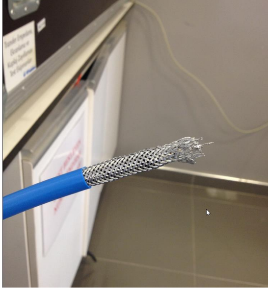
řekil 3.25 Diren ile baėlantıları saėlanmış kablo ucunun son hali
