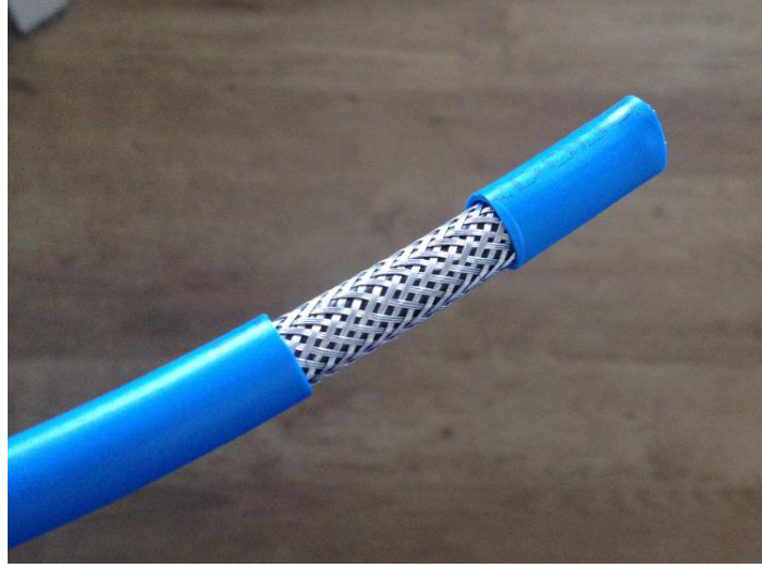
Şekil 3.23 Kablo 5 'in galvanizli çelik tel örgü yapısı
