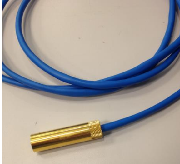
Şekil 3.11 CoMeT'e bağlamaya hazır hale getirilen kablo ucu
