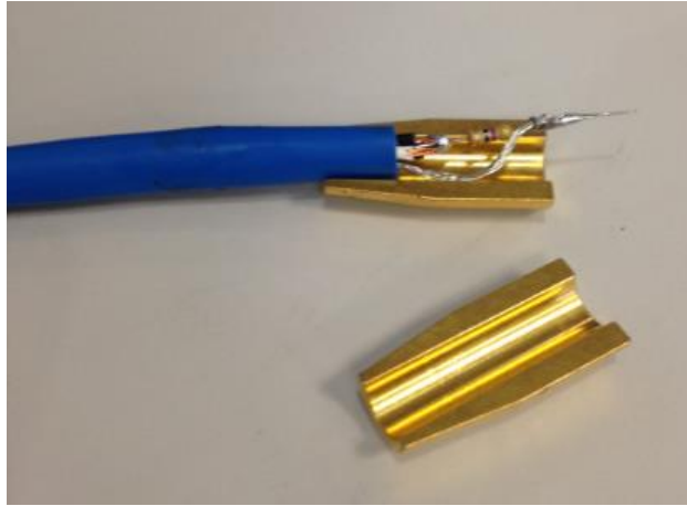
Şekil 3.9 Kablo ucunun CoMeT aparatı ile sabitleştirilmesi
