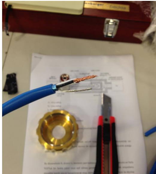
Şekil 3.15 Kablo 2 iletkenleri ve toprak teli
