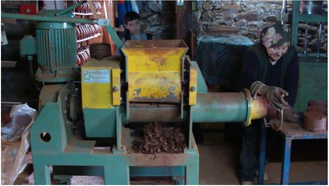
Resim 6: Vakum Pres (Fotoęraf: Arzu Emel Altınkılı)
