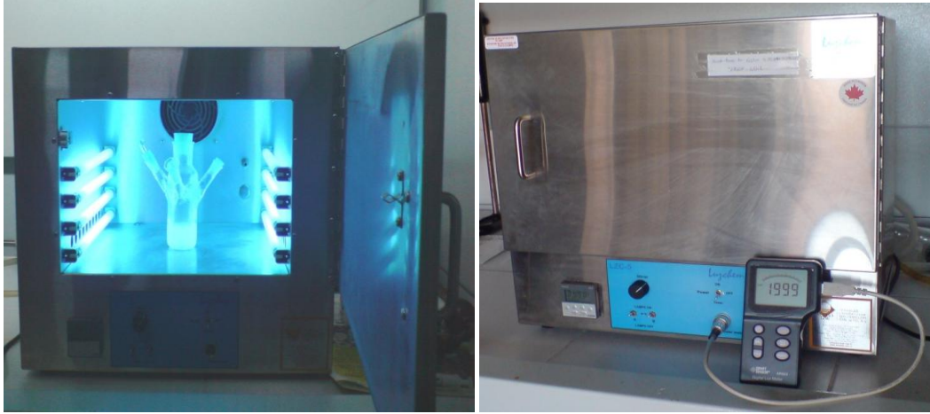
Şekil 3.2: Fotokatalitik reaksiyonlarda kullanılan fotoreaktörün reaksiyon esnasında iç ve dış görünümü.
