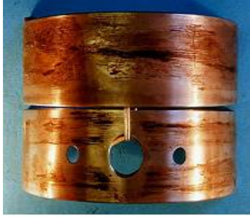
Şekil 9. Aşınmalı korozyona uğramış bir makine parçası.
