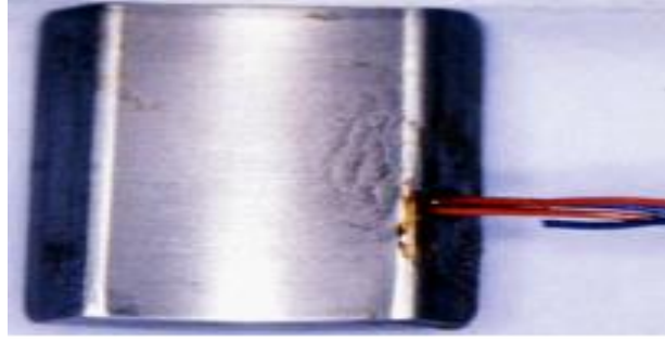
Şekil 6. Elektrik akımı korozyonuna bir örnek
