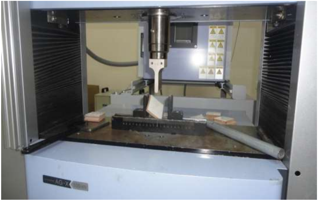
Şekil 3.4 KT 1 Deney numunesinin uygulanan kuvvetle kırılması
